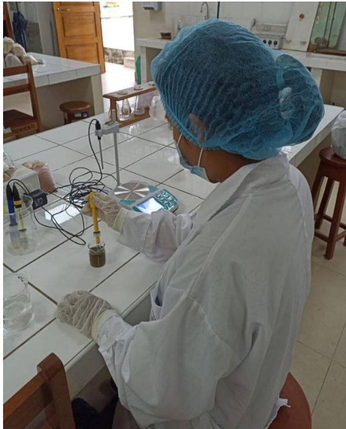
Figura 6. Análisis de lixiviado (Temperatura, pH, conductividad eléctrica y SDT).
