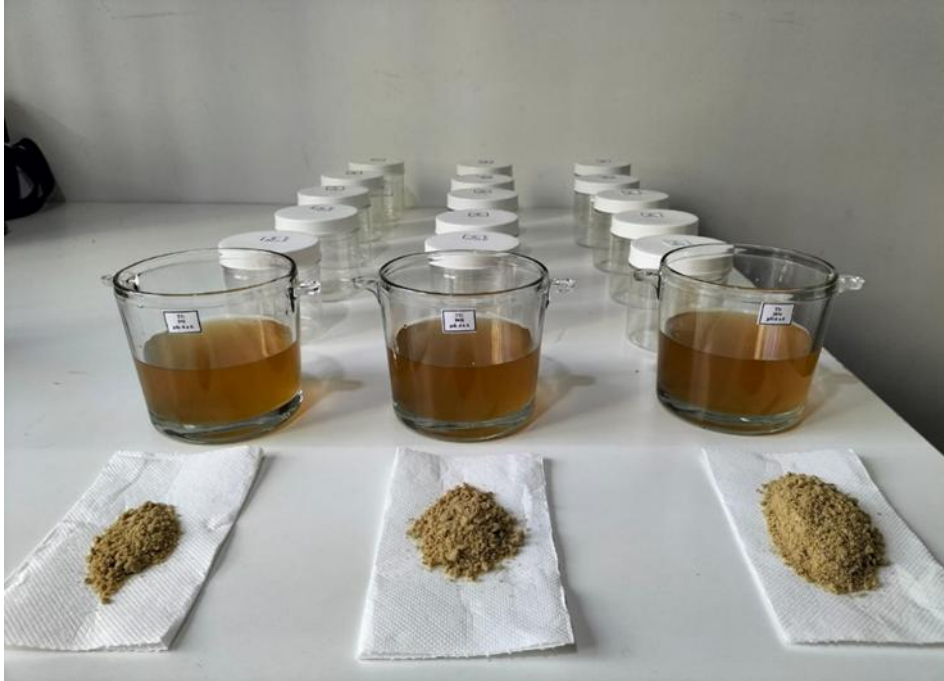
Figura 21. Sistema experimental para la aplicación del polvo de semillas de moringa al lixiviado
