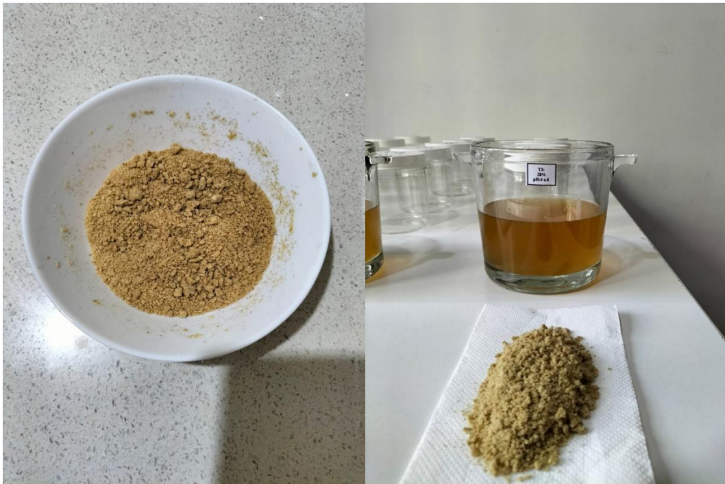
Figura 20. Preparación del polvo de semillas de moringa
