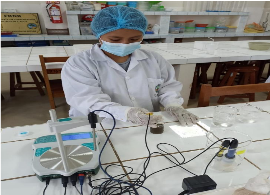
Figura 18. Medición de los parámetros fisicoquímicos del lixiviado
