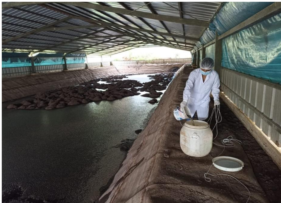
Figura 5. Recolección de lixiviados mediante el muestreo compuesto.
