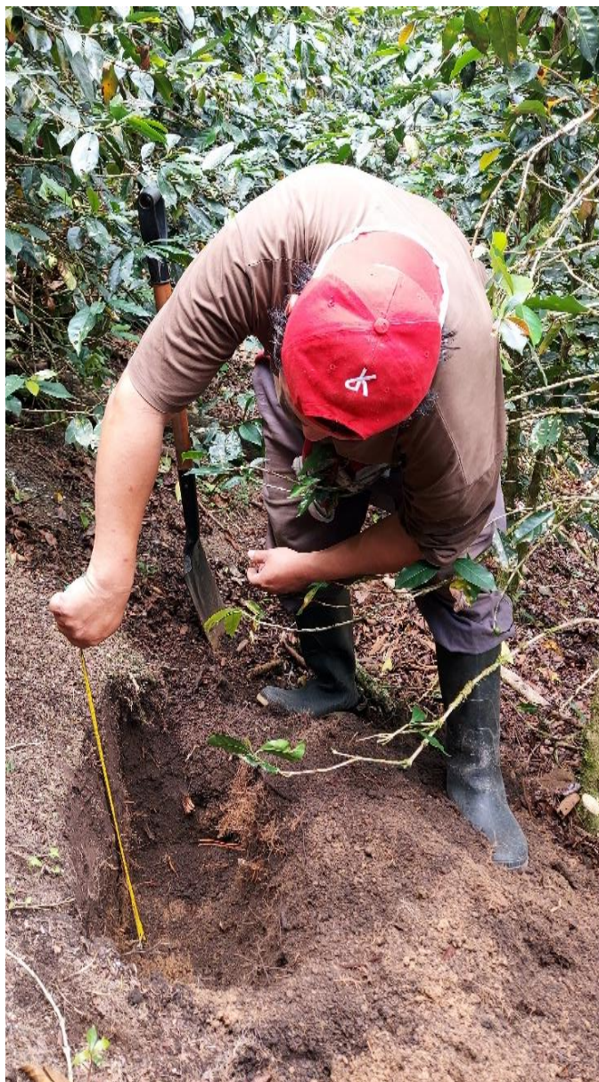
Figura 21. Toma de lectura de las profundidades para el muestreo de suelos, sector Gramazú, CC. NN. Tsachopen.
