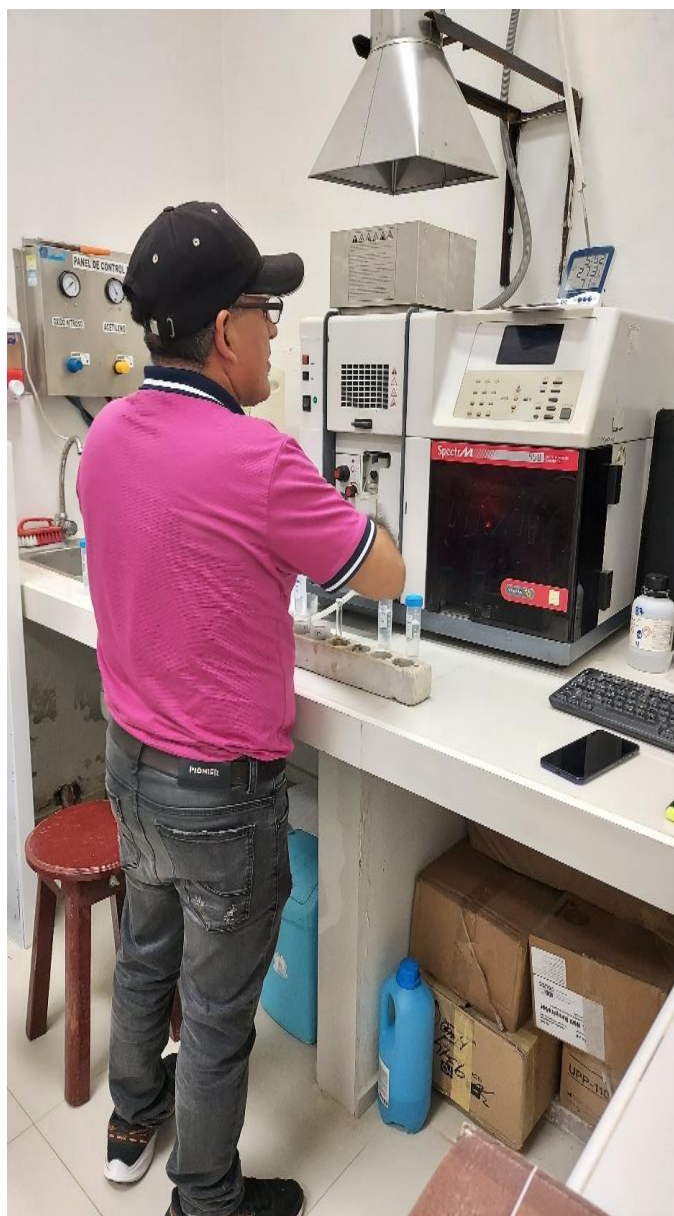
Figura 33. Calibración de la espectrometría de absorción atómica, Laboratorio de Análisis de Suelos, Agua y Ecotoxicología de Facultad de Agronomía de la Universidad Nacional Agraria de la Selva.
