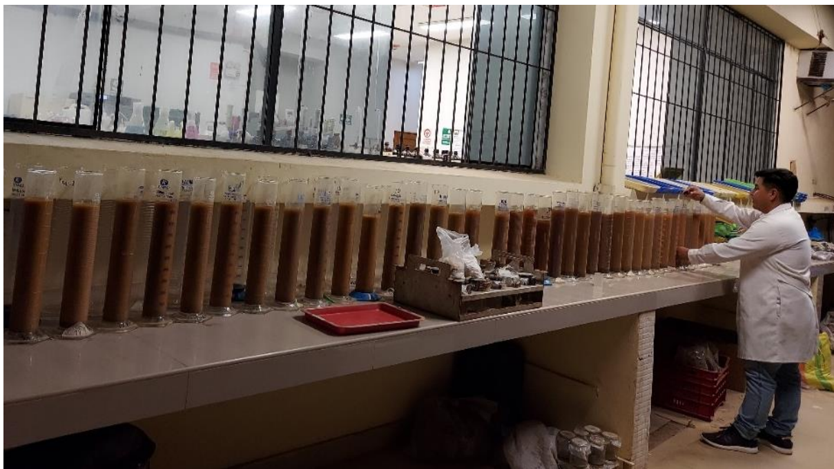
Figura 36. Determinando la textura de las muestras de suelo de los sistemas agroforestales C. arabica - I. macrophylla .
