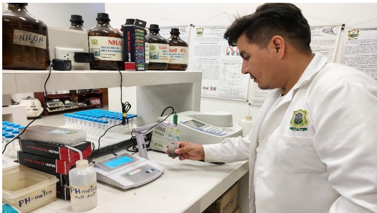
Figura 38. Determinando el pH del suelo, Laboratorio de Análisis de Suelos, Agua y Ecotoxicología de Facultad de Agronomía de la Universidad Nacional Agraria de la Selva.
