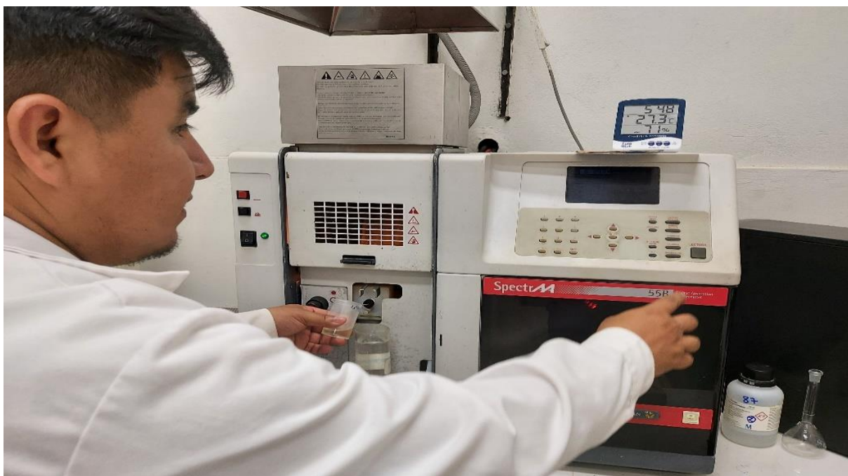
Figura 34. Cuantificación de la concentración de los micro y macroelementos químicos, Laboratorio de Análisis de Suelos, Agua y Ecotoxicología de Facultad de Agronomía de la Universidad Nacional Agraria de la Selva.
