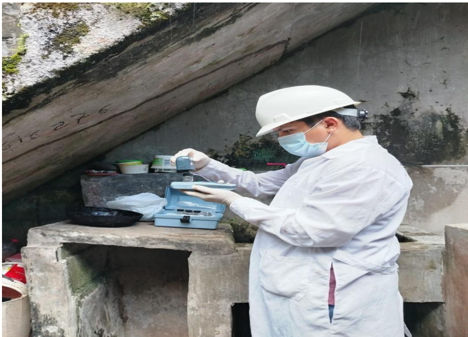
Figura 42. Toma de valor de cloro residual en vivienda.
