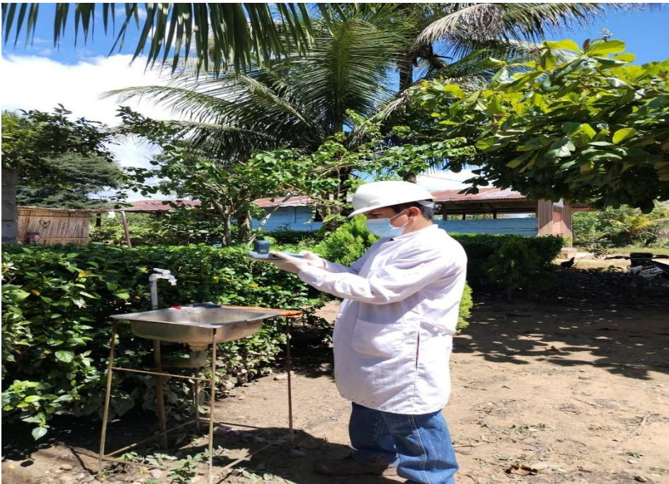
Figura 38. Medición de cloro residual en restaurant.
