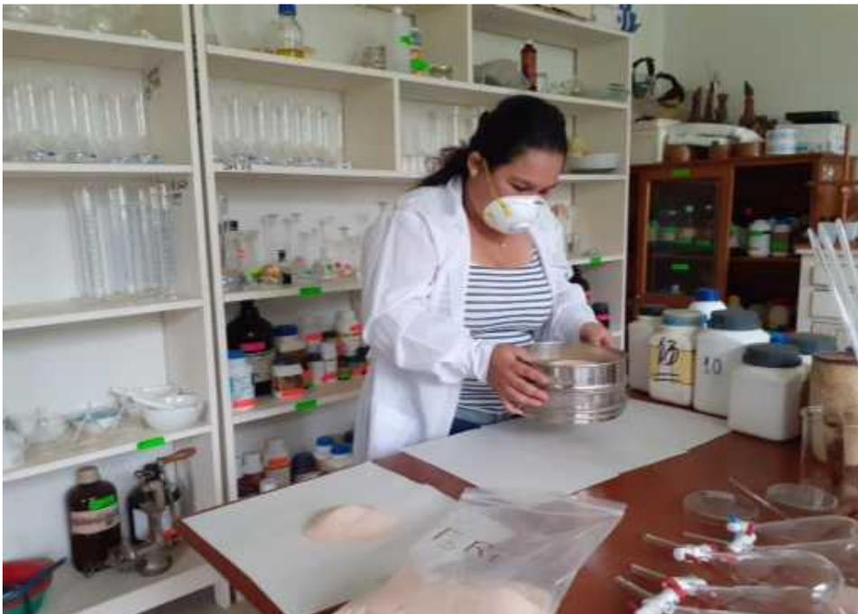
**Figura 10.** Tamizado de las muestras con las mallas granulométricas en el laboratorio.
