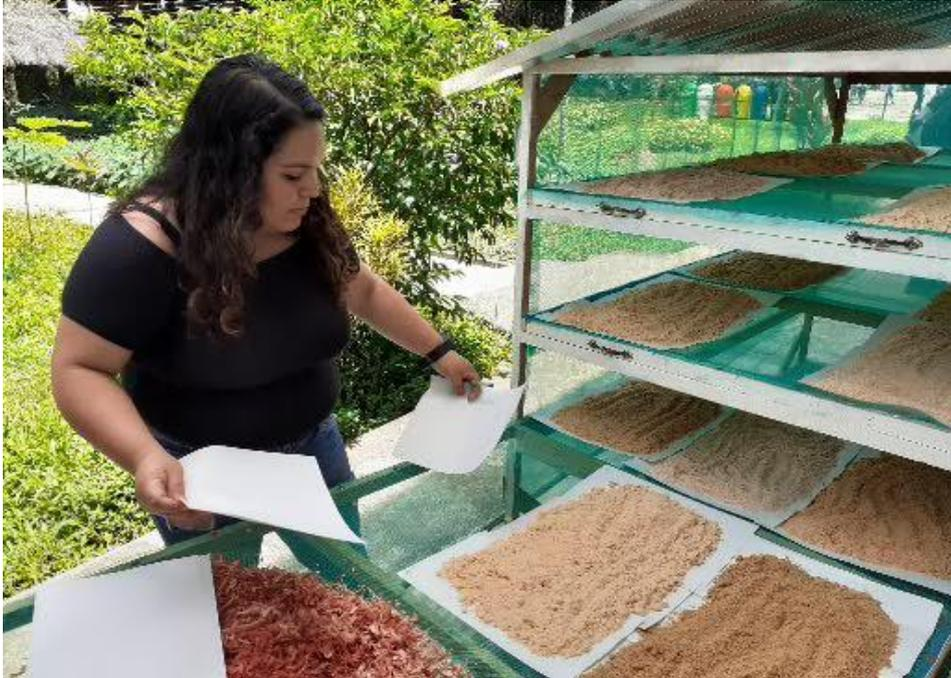
**Figura 9.** Secado de las muestras para la pérdida de humedad en el secador solar.
