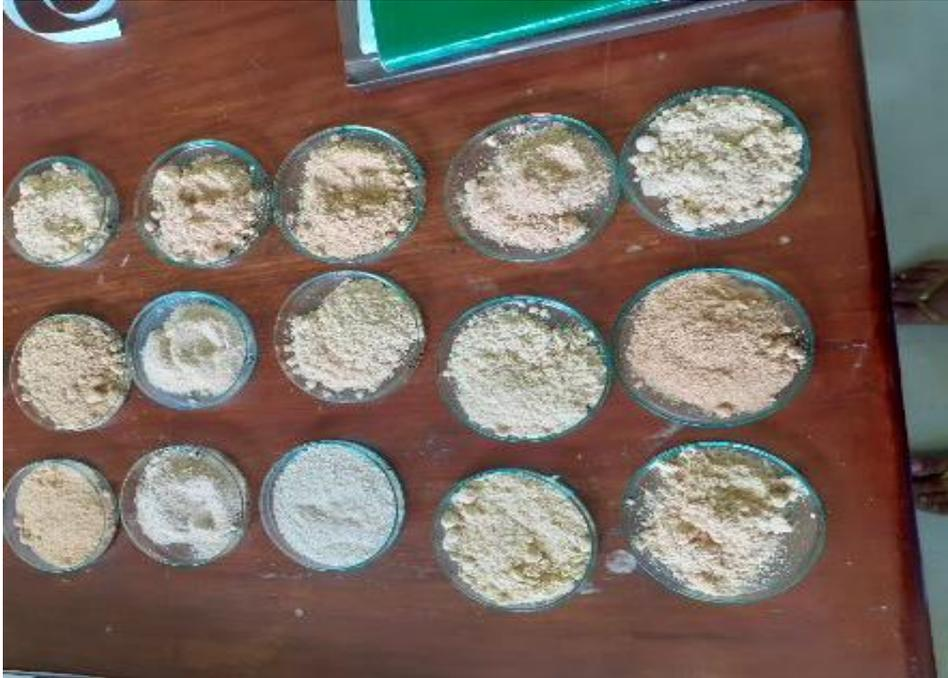
**Figura 11.** Muestras tamizadas de cada nivel del fuste para ser llevadas a la estufa.
