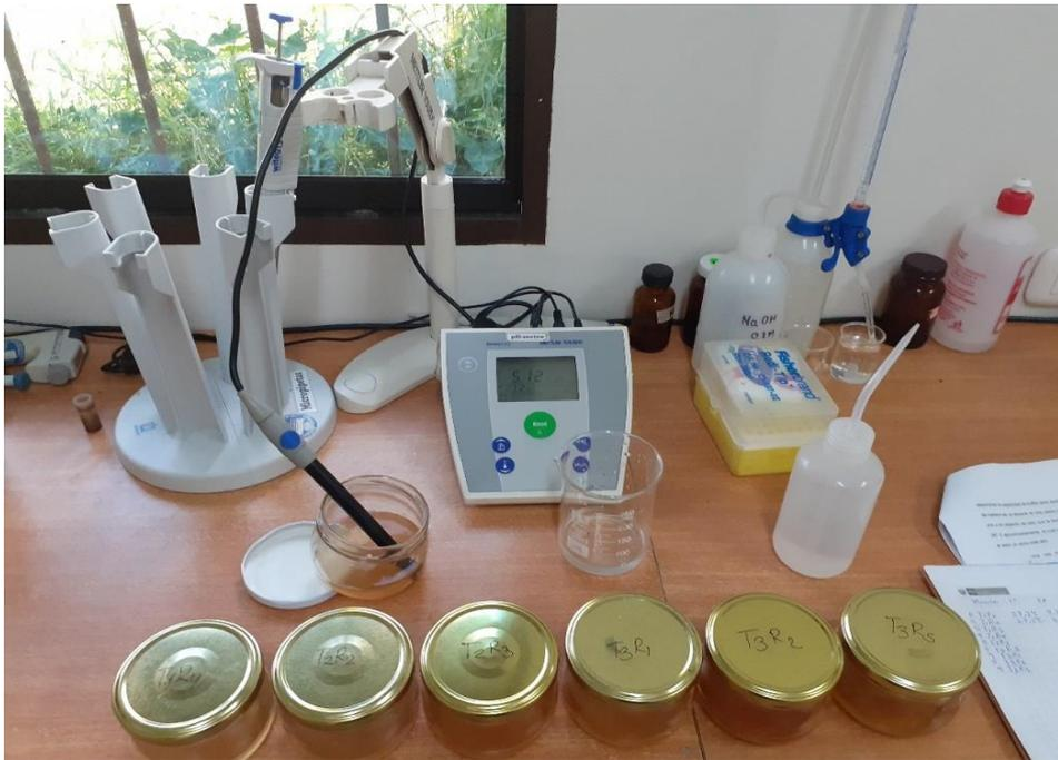
**Figura 14.** Obtención de los valores del pH de cada muestra de los tres niveles del fuste.
