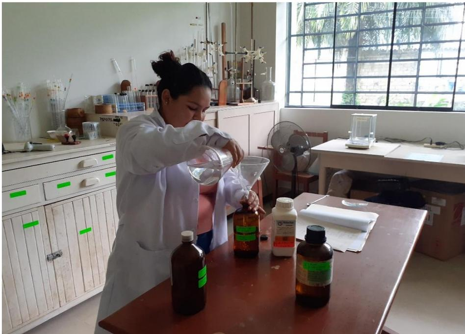
**Figura 12.** Preparación de los reactivos NaOH Y HCl para la obtención de la capacidad buffer.
