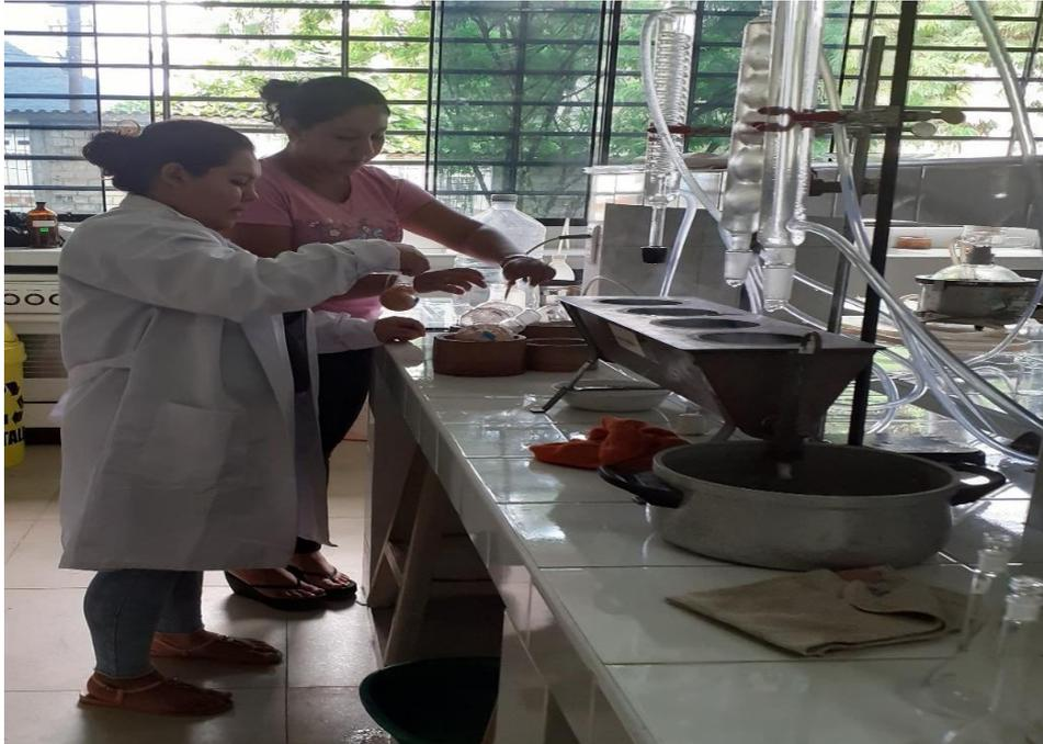
**Figura 13.** Extracción de las muestras a través del equipo Soxhlet.
