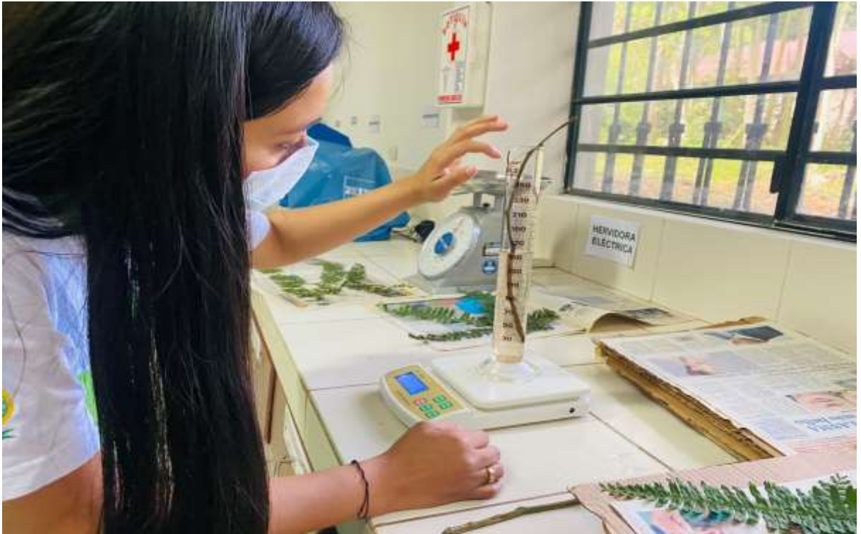
Figura 16. Peso y calculo por desplazamiento del volumen verde para la densidad básica.
