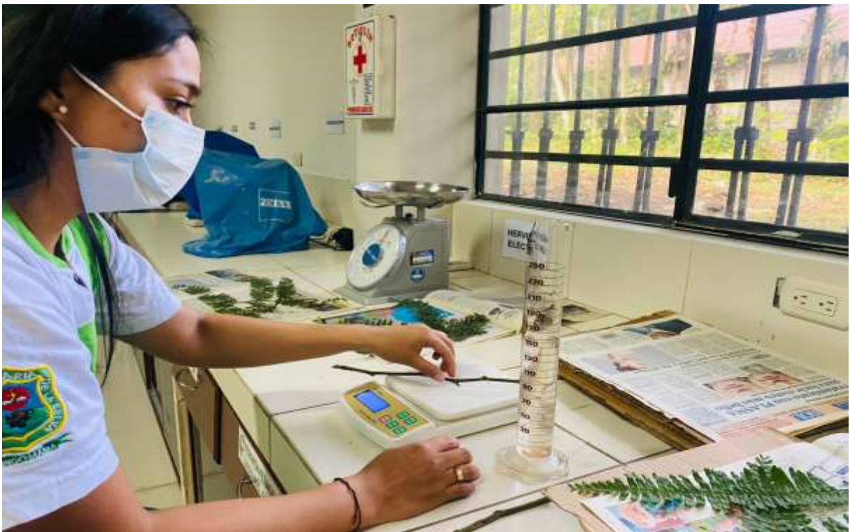
Figura 15. Peso fresco o húmedo de la muestra para el cálculo de densidad básica.
