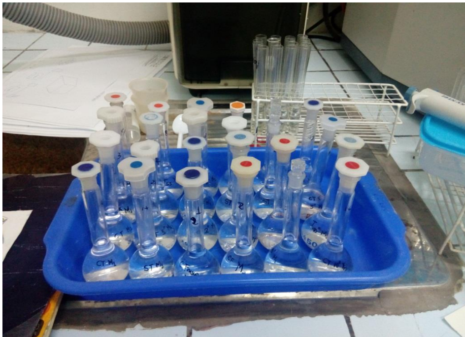
Figura 37. Diluciones para la lectura de Pb en el espectrofotómetro de absorción atómica
