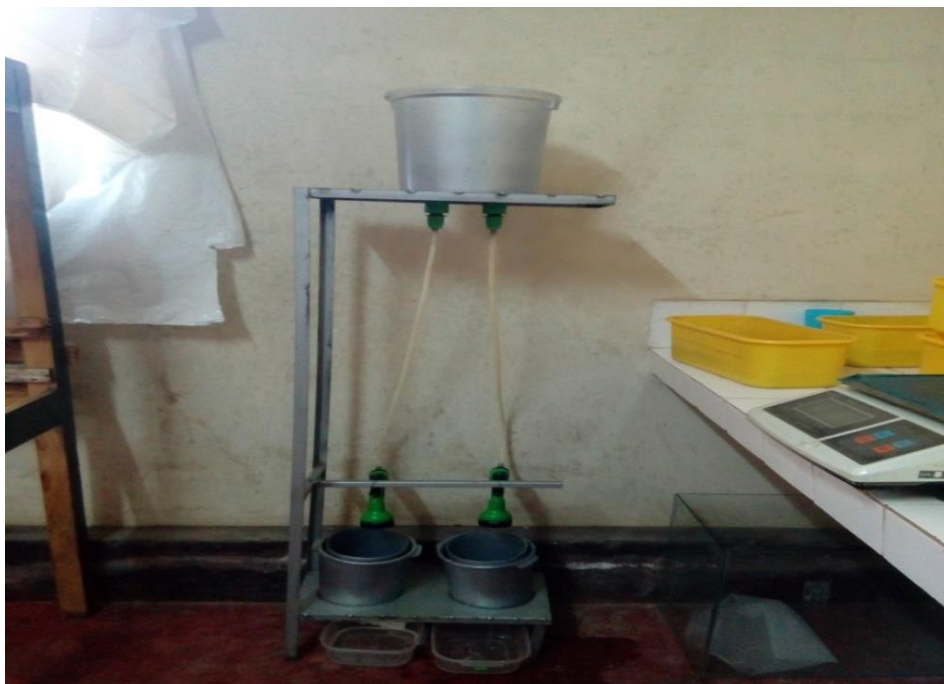
Figura 28. Acondicionamiento del equipo de lavado de suelo a escala laboratorio
