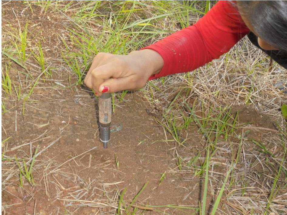
Figura 22. Evaluación de la resistencia de penetración a cero 0 cm. de profundidad.
