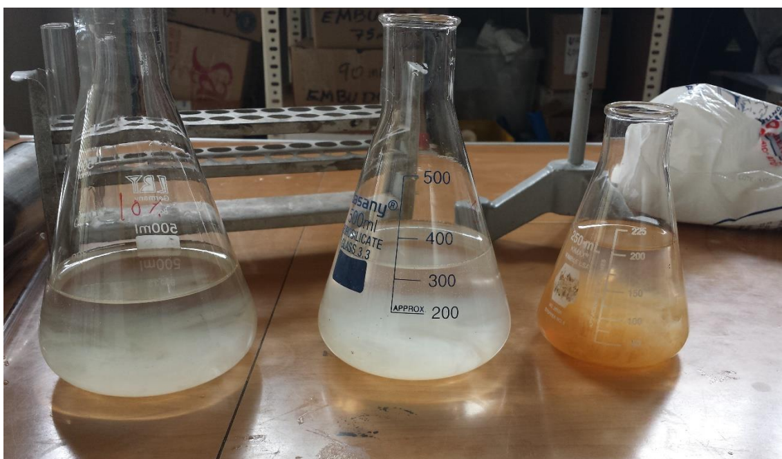
Foto 4. Ensayo de BBO5 por el método de Winkler nótese el color blanco que indica la presencia oxígeno en la muestra y el color carmesí que indica la ausencia de oxígeno en la muestra.
