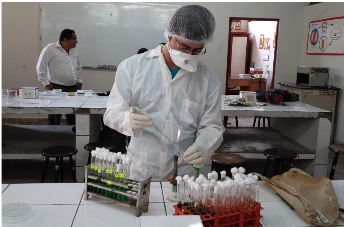
Foto 1. Análisis de Muestras del NMP de coliformes Totales.
