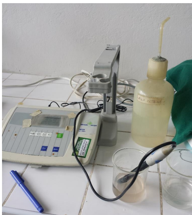
Foto 6: Medición del pH con el Metler MP 220.
