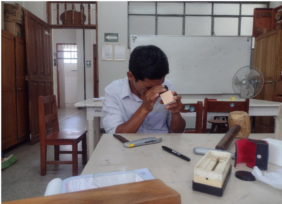
Figura 19. Visualización de características macroscópicas de D. peruviana con una lupa de aumento 10X.
