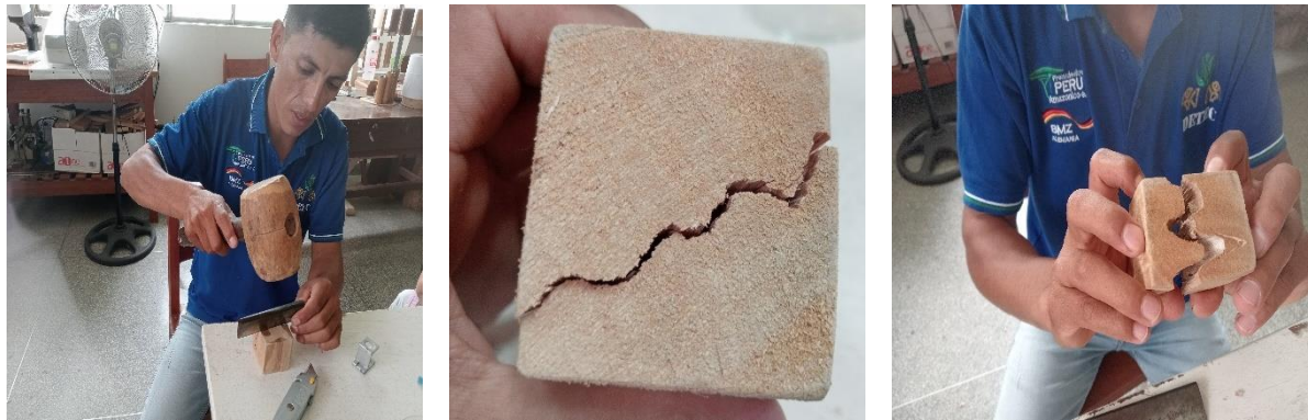
Figura 2. Determinación del grano siguiendo la dirección de los radios
