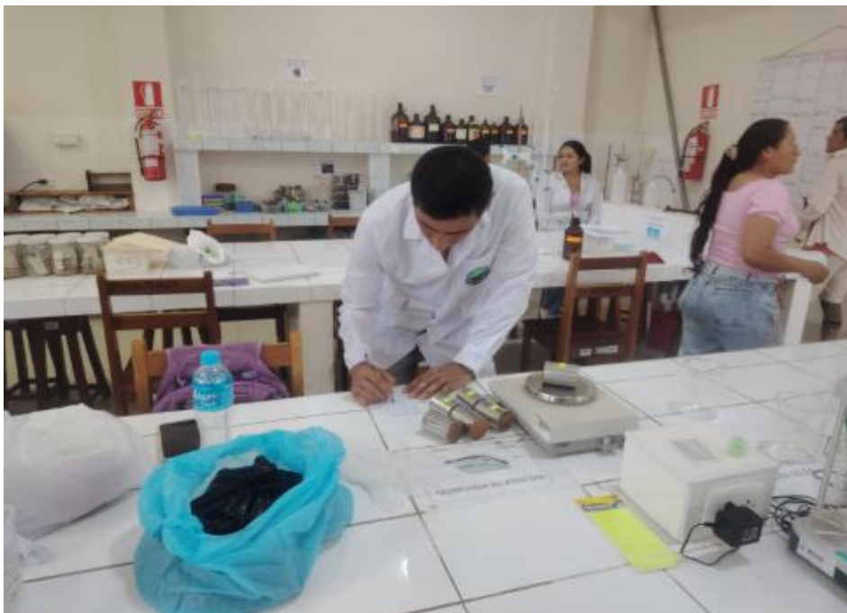
Figura 30. Medición del peso en seco para la determinación de la densidad aparente
