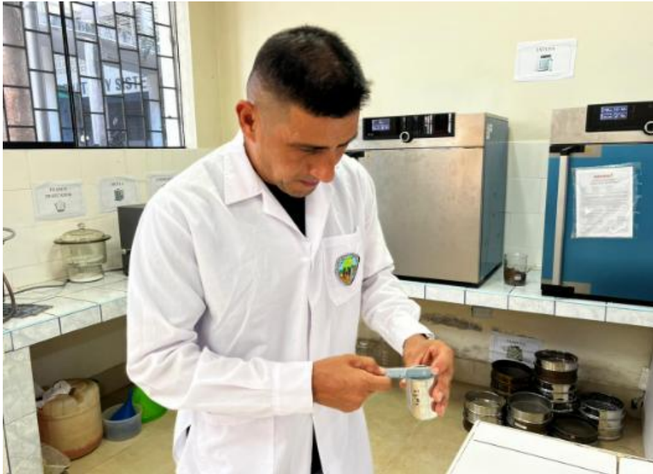
Figura 29. Medición de diámetro y altura para la determinación de densidad aparente
