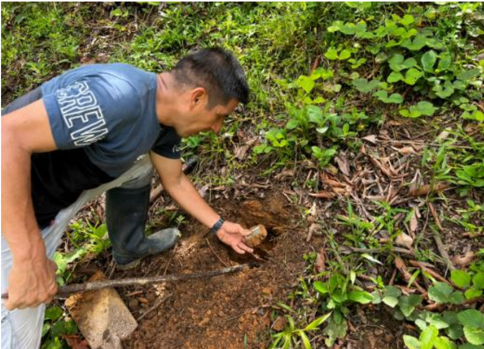
Figura 26. Muestreo para la determinación de densidad aparente del suelo
