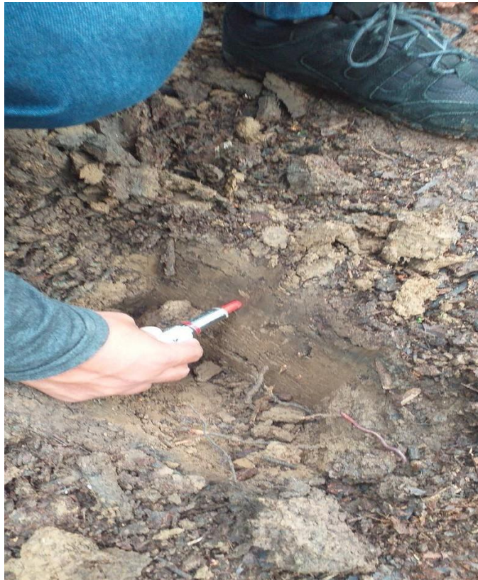
Figura 8. Medición de la resistencia a la penetración del suelo.
