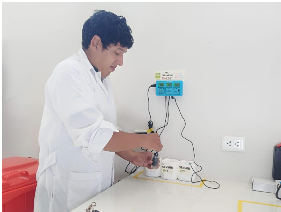
Figura 27. Lectura de pH y conductividad eléctrica con multiparámetro
