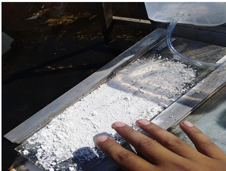
Figura 26. Cobertura de láminas con dióxido de titanio
