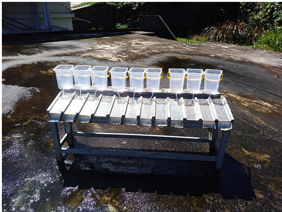
Figura 25. Acondicionamiento del montaje de placas planas inclinadas a escala laboratorio
