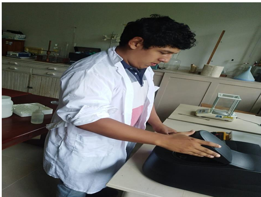
Figura 28. Lectura de muestras en el espectrofotómetro UV- Vis
