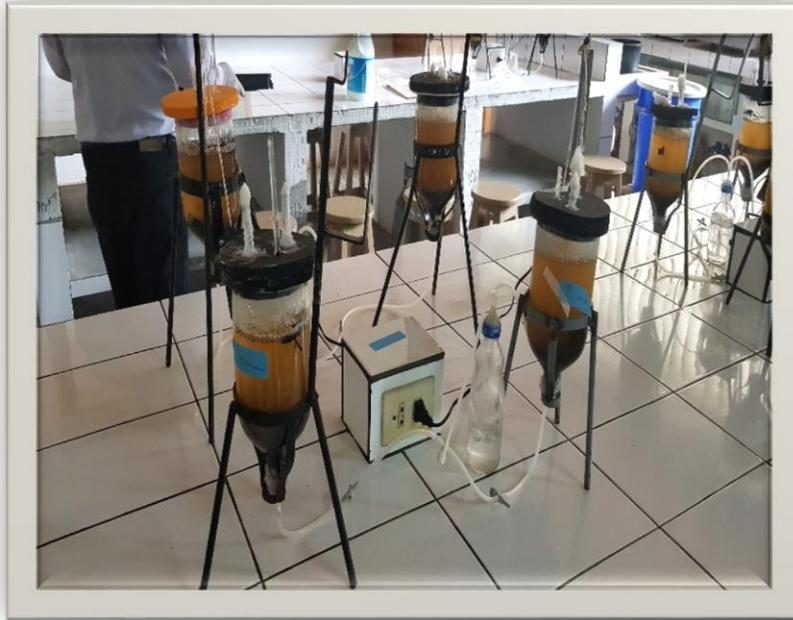
Foto 3: Biorreactores en funcionamiento para iniciar el proceso de biorremediación mediadas con *Pseudomonas spp.*
