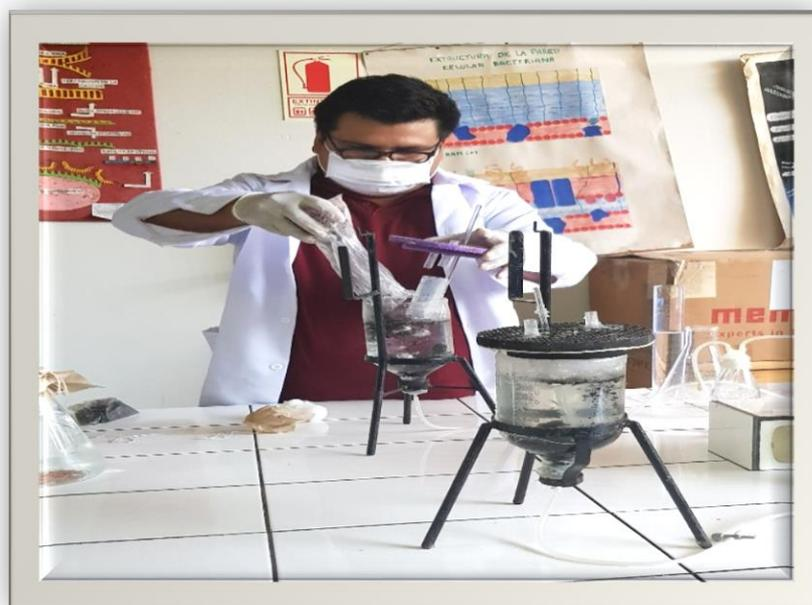
Foto 2: Armando los biorreactores con las dosis indicadas en la tesis, para la evaluación posterior.
