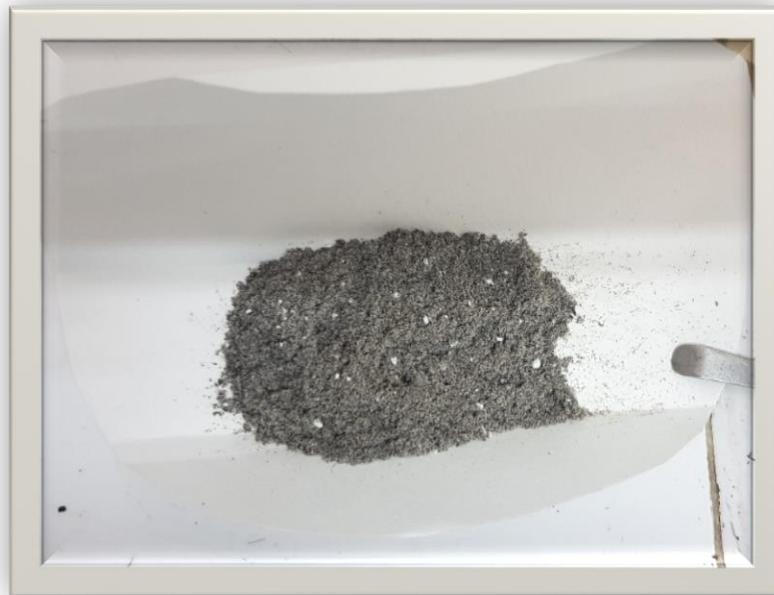
Foto 8: Preparando el suelo para su análisis en el método Soxhlet.
