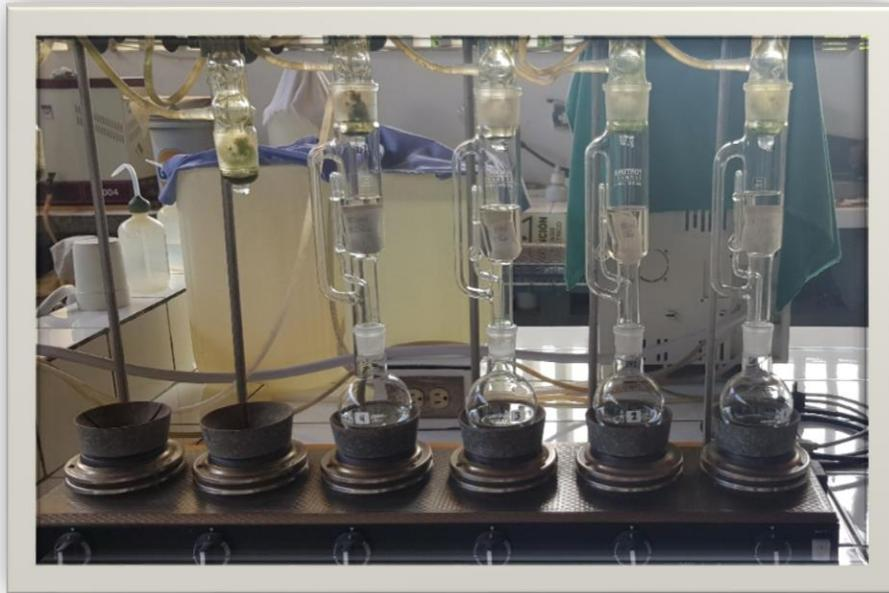
Foto 9: proceso de extracción de HTP con el método Soxhlet.
