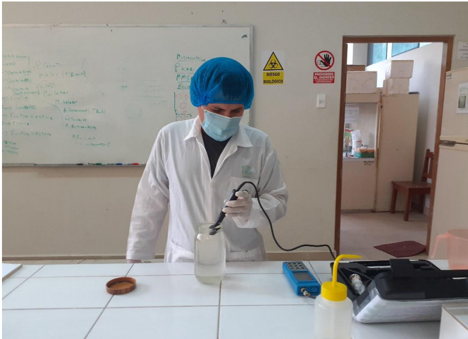
Figura 32. Medición del oxígeno disuelto en las muestras de agua.
