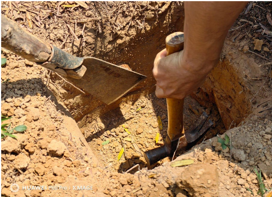
Figura 23. Obtención de la muestra de suelo a tres profundidades para su análisis en el laboratorio
