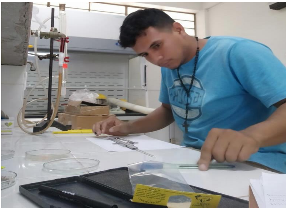
Figura 29. Medición de la longitud de las muestras obtenidas con el barreno de Pressler
