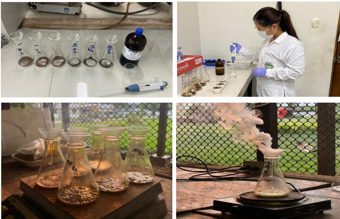
Figura 12. Preparación de la digestión para la determinación de cadmio y plomo.
