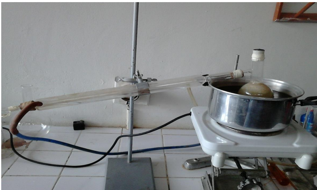
Figura 19. Destilación del mucilago de cacao
