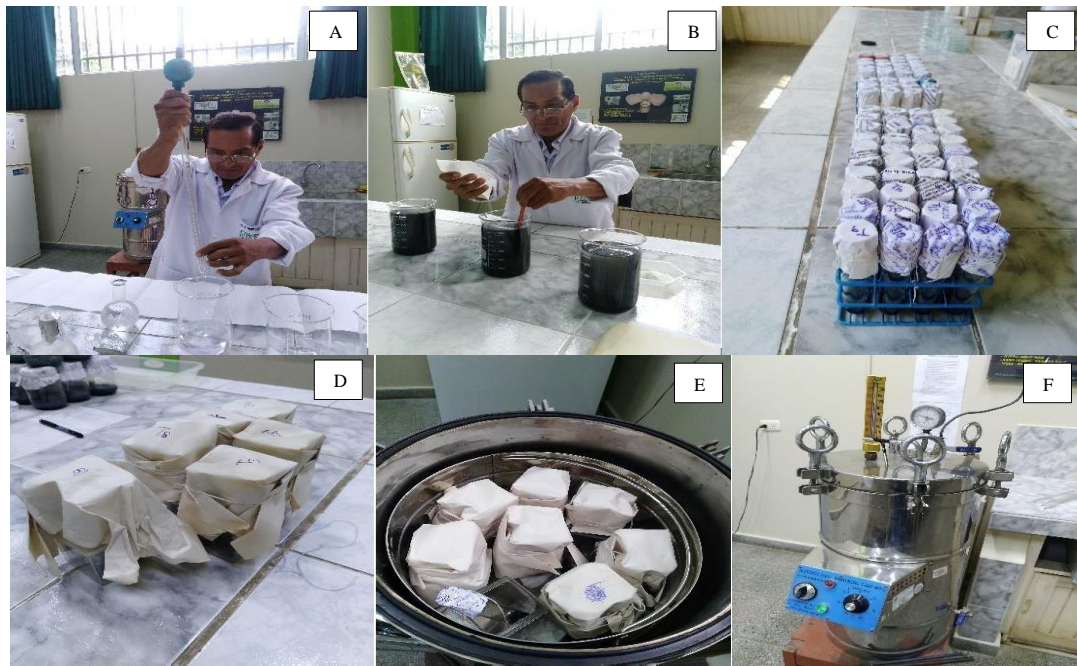
Figura 4. A) Estoqueado de medio cultivo, B) preparando y agregando agar, c) tubos de ensayo con medio, D) medio cultivo para esterilizar, E) medios colocados en autoclave, F) esterilización de medio cultivo.
