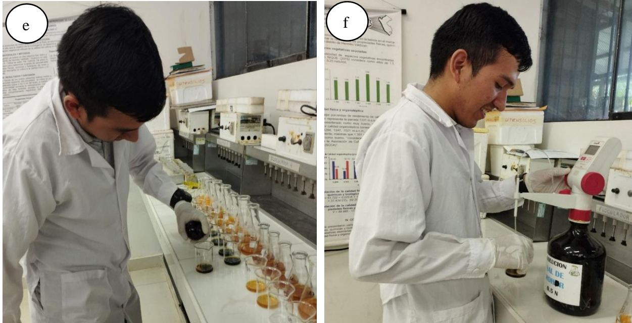
Figura 19. Determinación de la M.O: a. Añadido de indicador difenilamina sulfúrica, f. Titulación con sulfato ferroso
