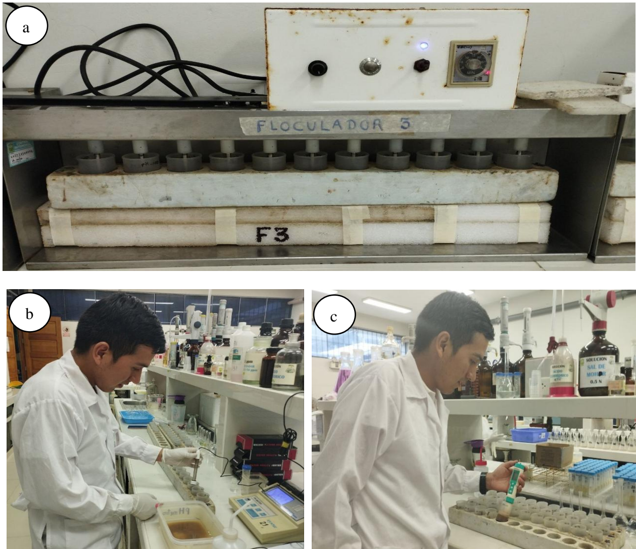
Figura 17. Determinación del pH y la C.E: a. Agitado de muestras, b. Lectura del pH, c. Lectura de la C.E.
