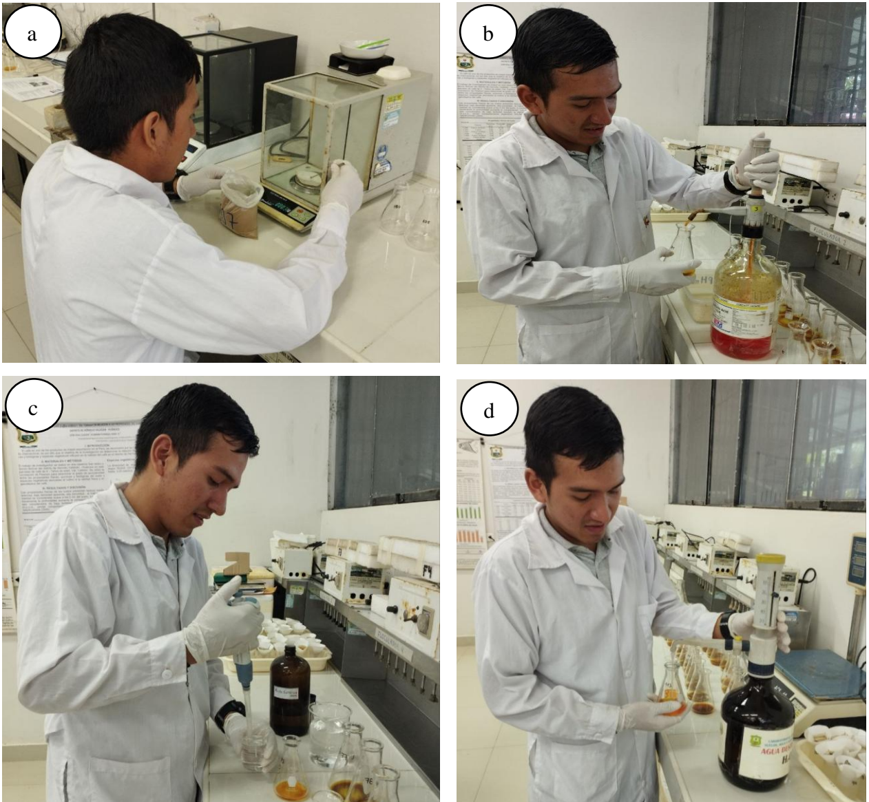
Figura 18. Determinación de la M.O: a. Pesado de muestra, b. Añadido de Dicromato de potasio, c. Añadido de ácido sulfúrico, d. Enraizado con agua destilada
