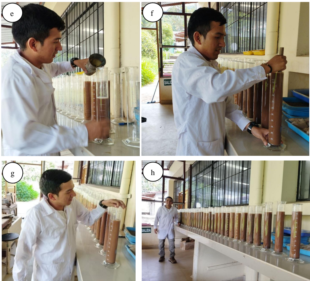
Figura 16. Determinación de la clase textural: e. Transferencia de muestras, f. Agitación de muestras, g. Lectura con el hidrómetro, h. Registro de lectura del hidrómetro
