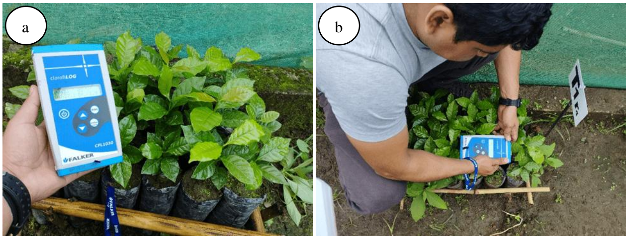
Figura 8. Determinación de clorofila: a. Calibración de equipo, b. Medición de clorofila
