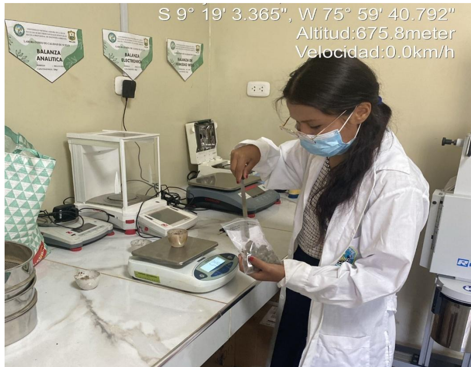
Figura 20. Medición de la humedad.
