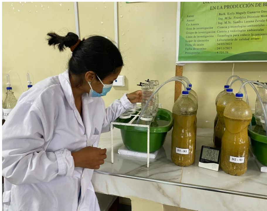
Figura 33. Verificación de la producción diaria de biogás.
