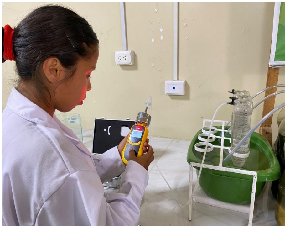
Figura 35. Medición de los gases finales con el analizador portátil de biogás.
