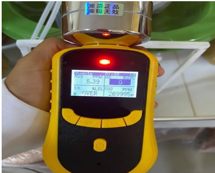
Figura 37. Medición de los gases de la Dilución 1 (1:2).
