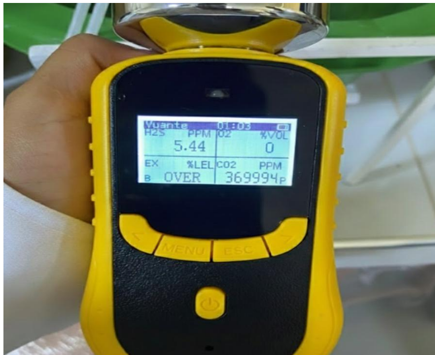
Figura 38. Medición de los gases de la Dilución 2 (1:3).
