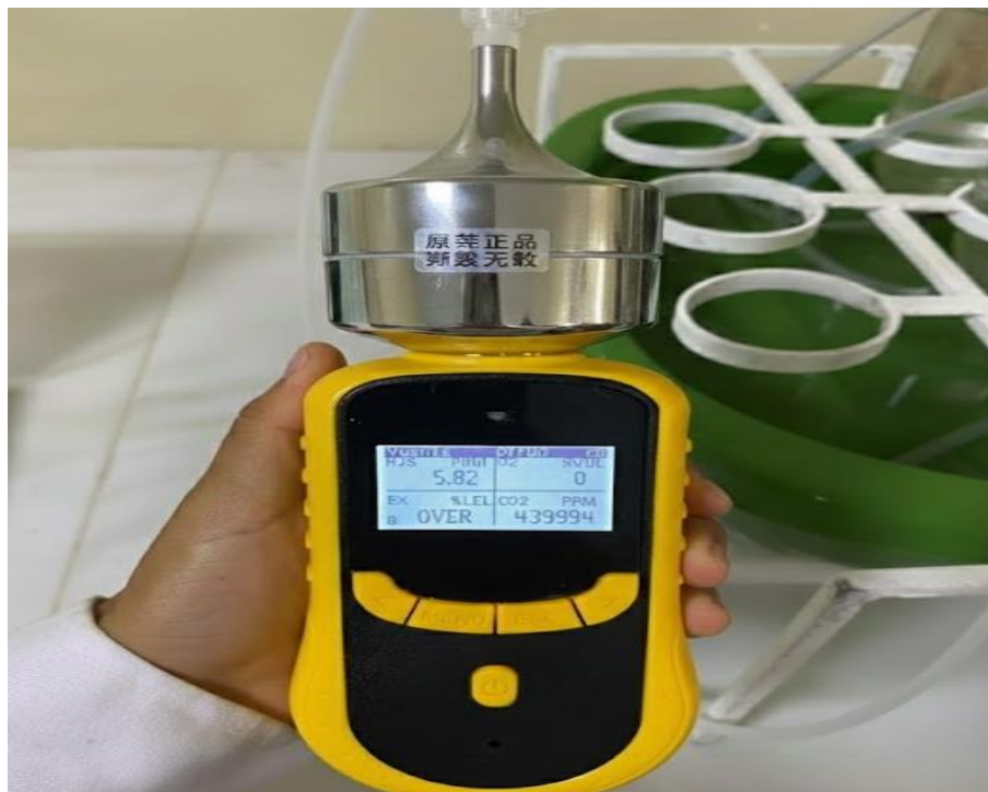
Figura 39. Medición de los gases de la Dilución 3 (1:4).
