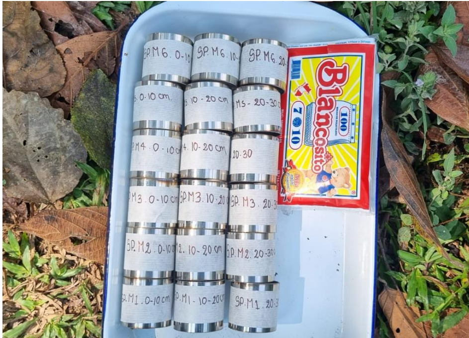
Figura 9. Cilindros Uhland previamente rotulados para la toma de muestras de suelos.
