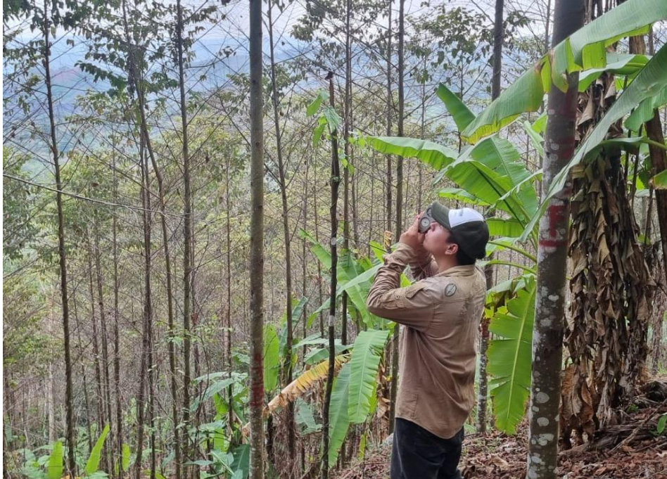
Figura 15. Medición de la altura total de los árboles con el clinómetro en el sistema de uso forestal.
