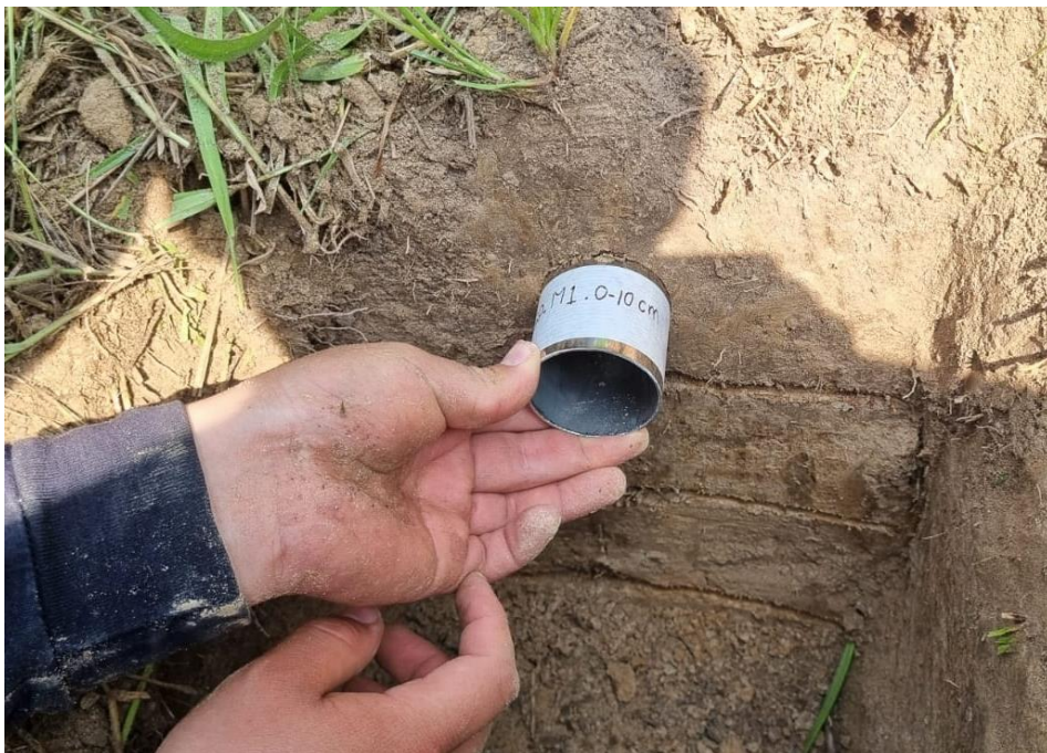
Figura 12. Toma de muestra del suelo mediante el uso de un cilindro rotulado.
