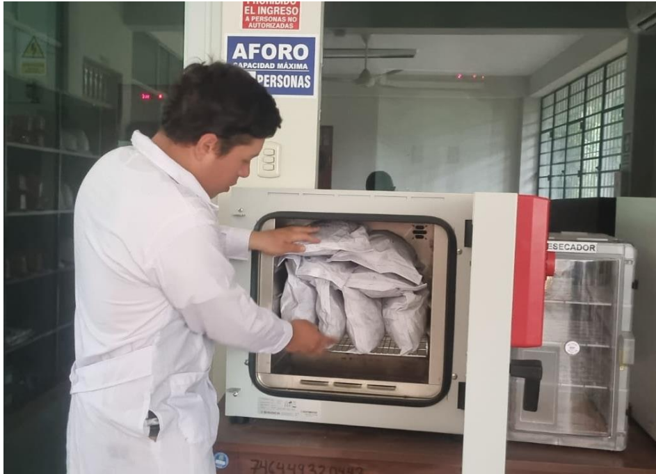
Figura 29. Colocado de las muestras de herbácea y hojarasca en la estufa eléctrica de la EPIRNR.
