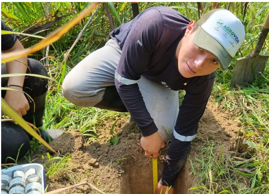
Figura 10. Calicata aperturada con dimensiones de 30 cm para la muestras de suelo.
