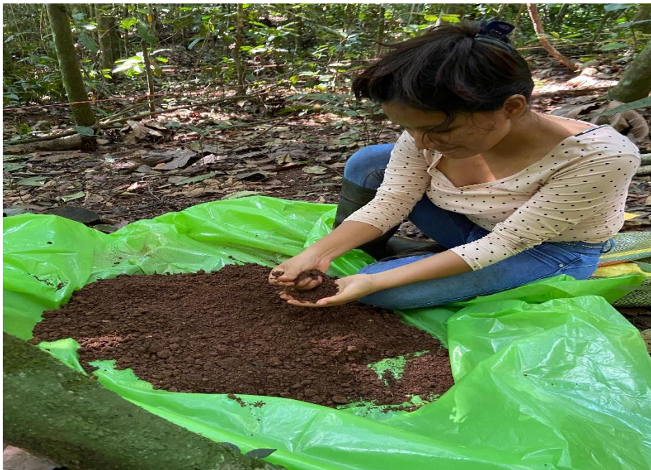
Figura 12. Homogeneización de la muestra de suelo.
