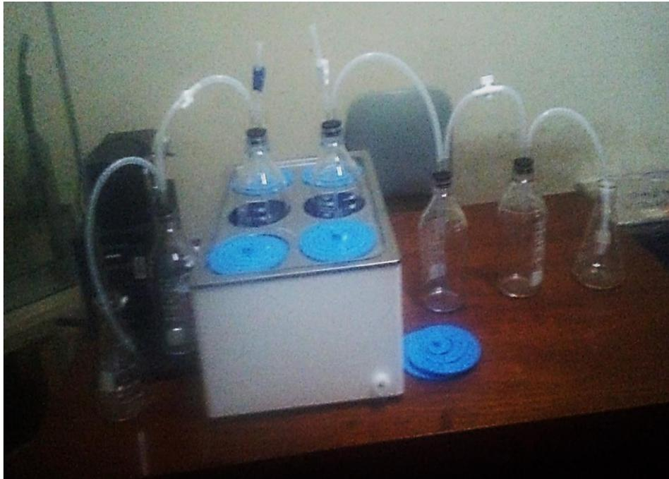
Figura 2. Sistema para el cálculo de la generación de biogás y metano
