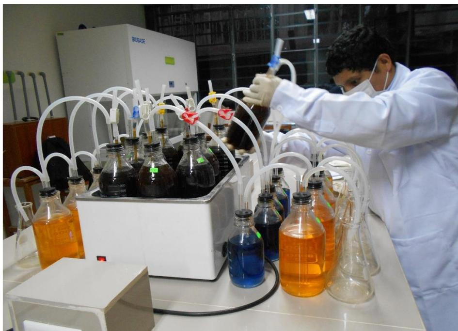
Figura 24. Medida de la generación de biogás y biometano
