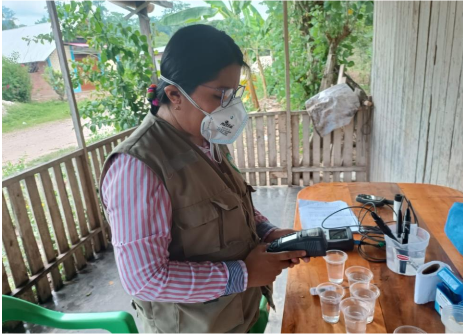
Figura 48. Análisis multiparamétrico de las muestras de agua
