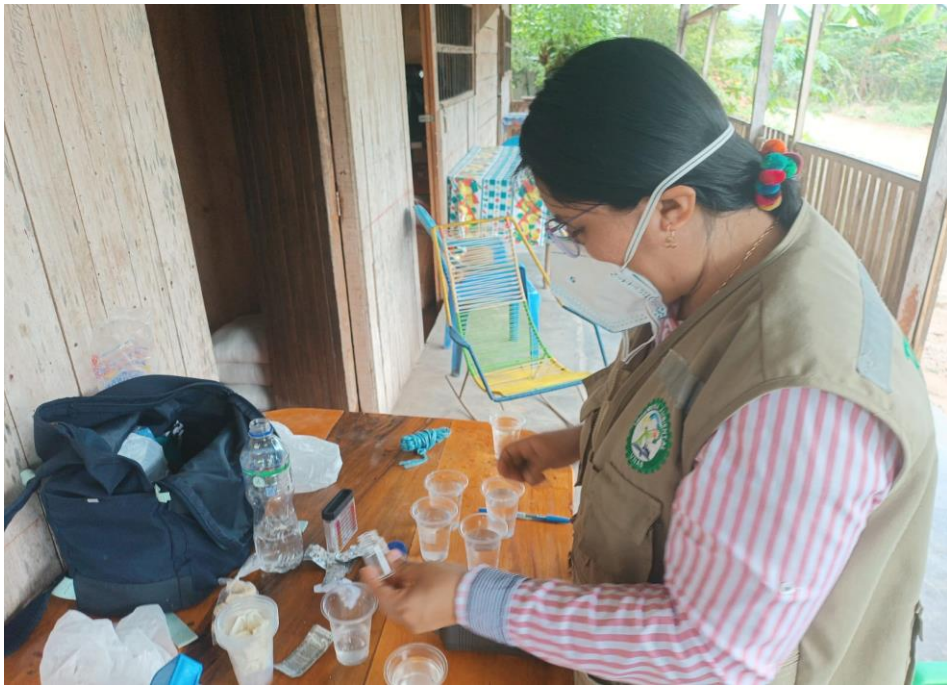
Figura 46. Determinación de la turbidez en las muestras de agua
