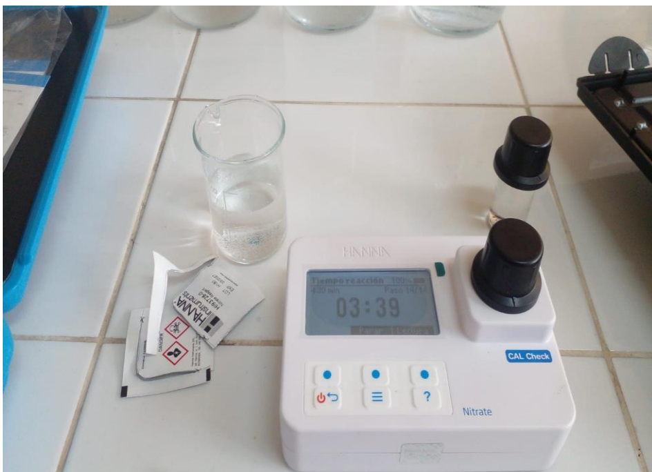
Figura 51. Determinación de nitratos en la muestra de agua
