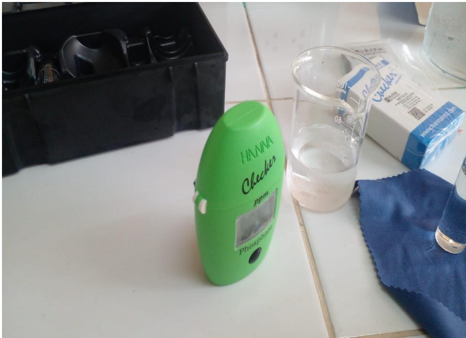
Figura 52. Determinación de fosfatos en las muestras de agua
