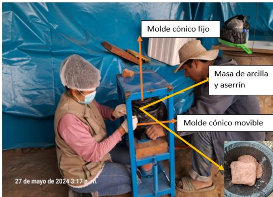
Figura 15. Prensado del barro (arcilla y aserrín)- alfarería Saul.
