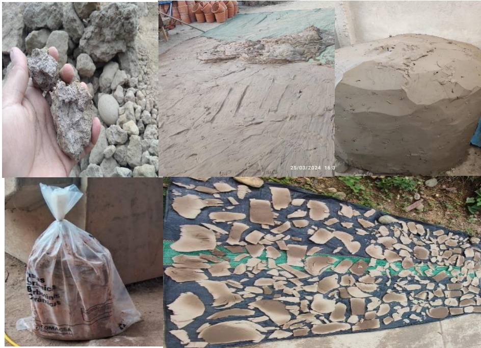
Figura 10. Obtención de la arcilla y secado.
