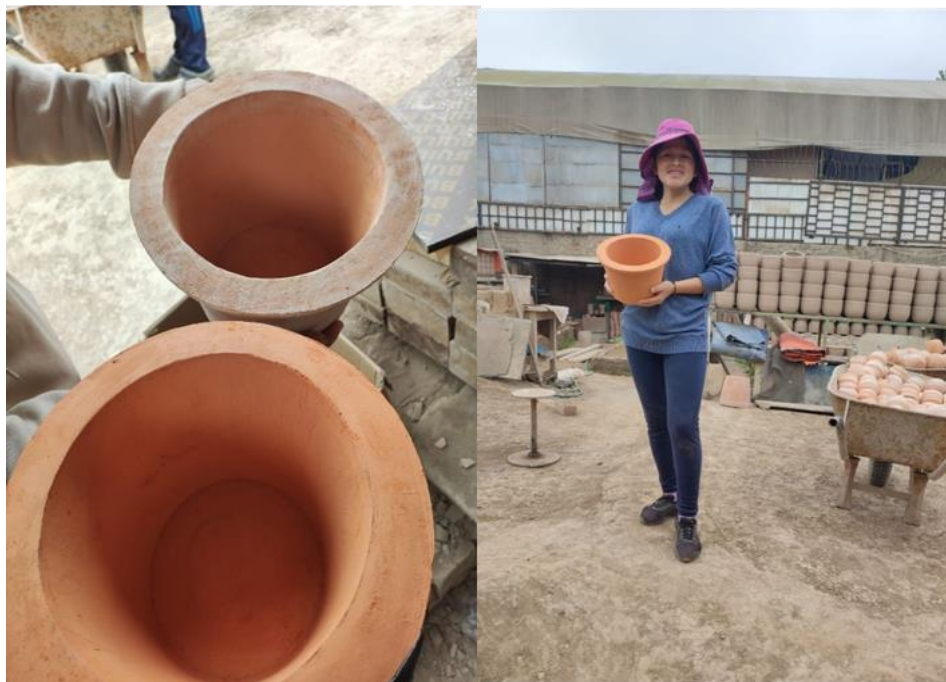
Figura 21. Obtención de la unidad filtrante.
