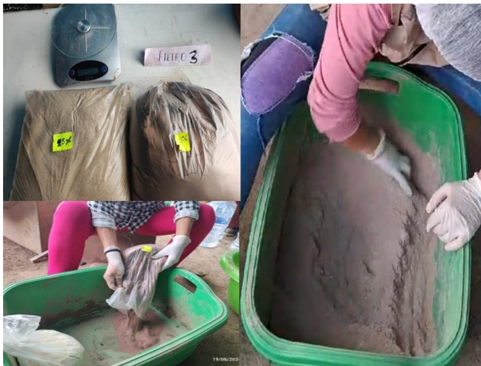
Figura 13. Pesaje y mezclado de arcilla y aserrín.
