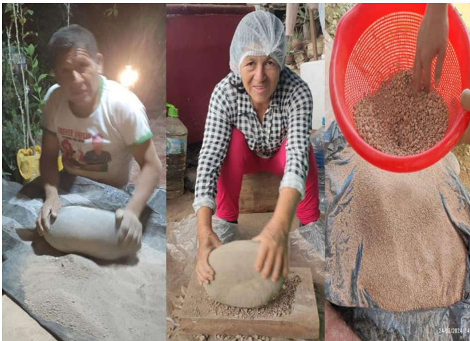
Figura 11. Molienda y tamizado de arcilla.
