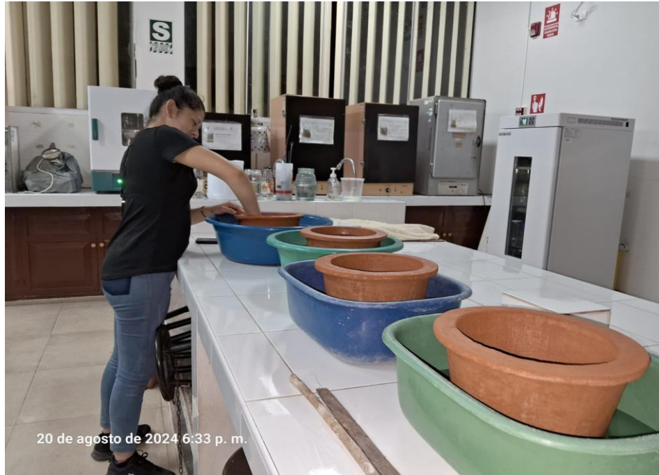
Figura 22. Lavado del filtro cerámico.
