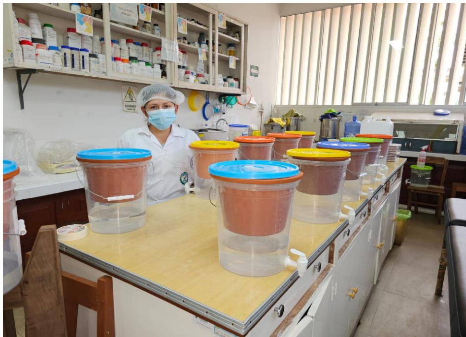
Figura 33. Proceso de filtración.
