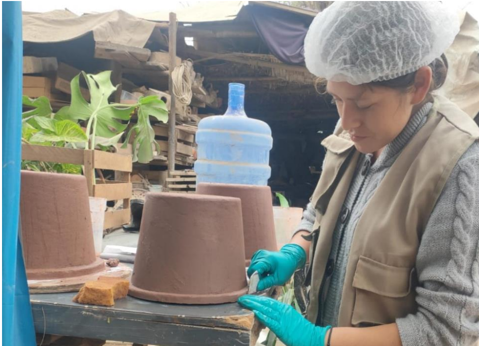
Figura 18. Secado de las unidades filtrantes a temperatura ambiente.
