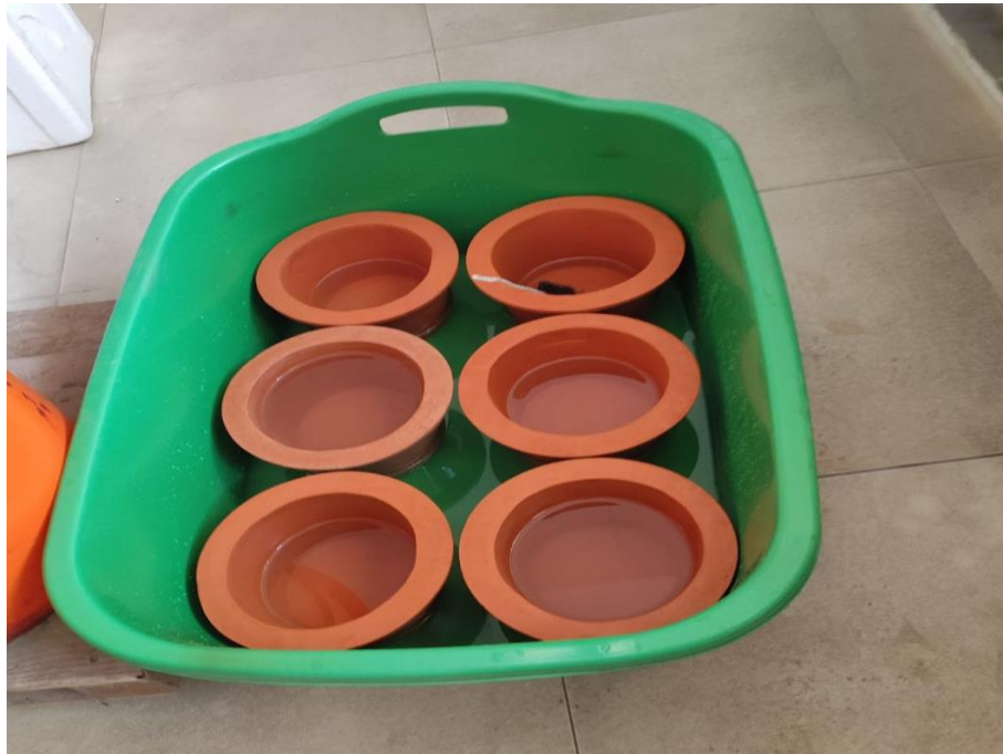
Figura 23. Saturación de los filtros de cerámica en un recipiente con agua por 4 horas.
