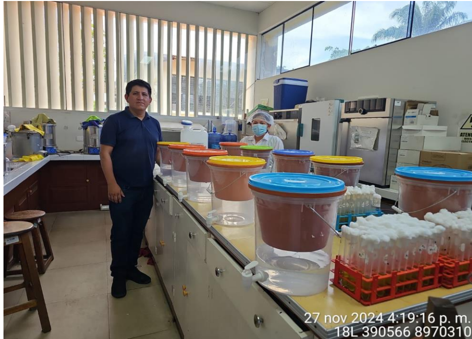
Figura 34. Operación de los filtros de cerámica con mi asesor.
