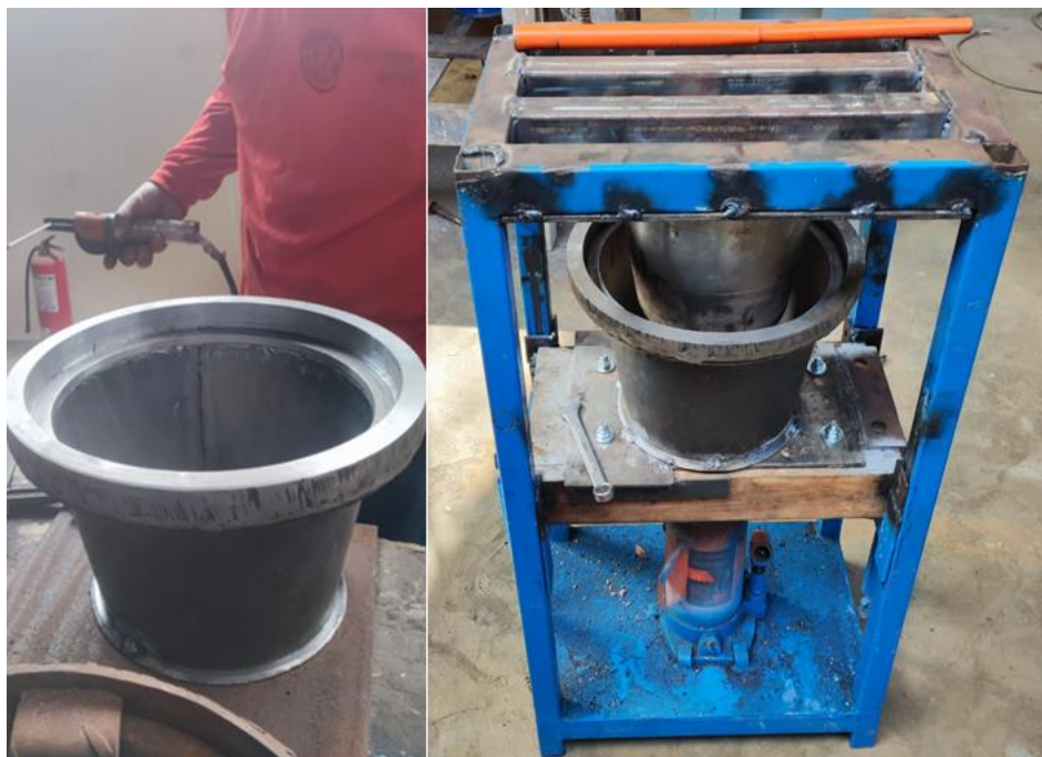
Figura 5. Construcción de la prensa hidráulica manual.
