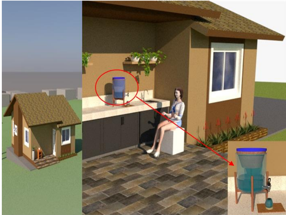
Figura 42. Vivienda del caserío Antonio Raymondi – Las Vegas con su filtro de cerámica.
