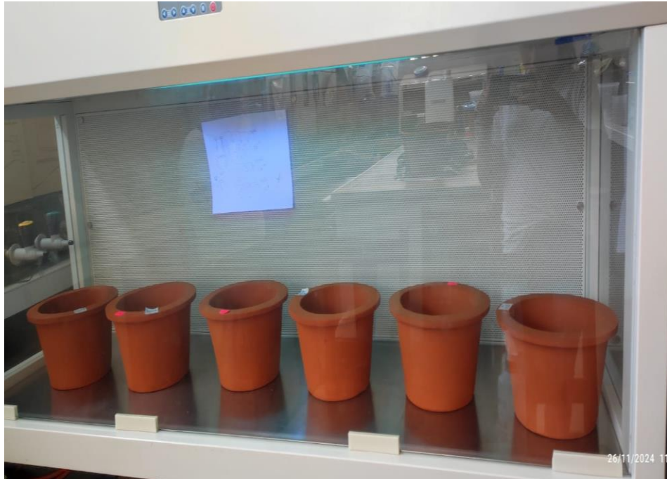
Figura 32. Esterilizando con luz UV a los filtros cerámicos.
