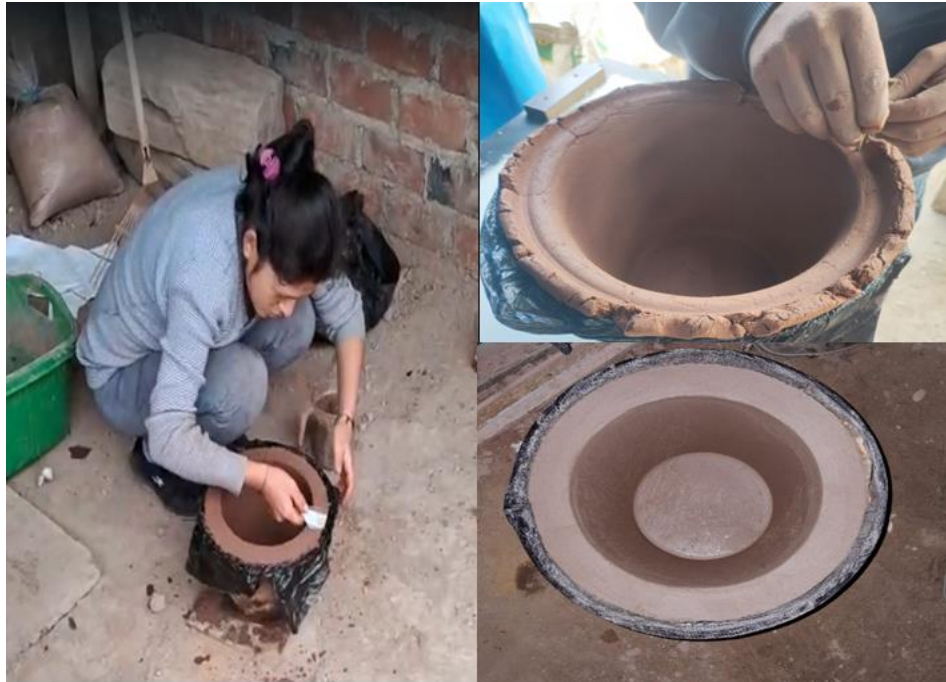
Figura 16. Moldeando la superficie del filtro crudo.
