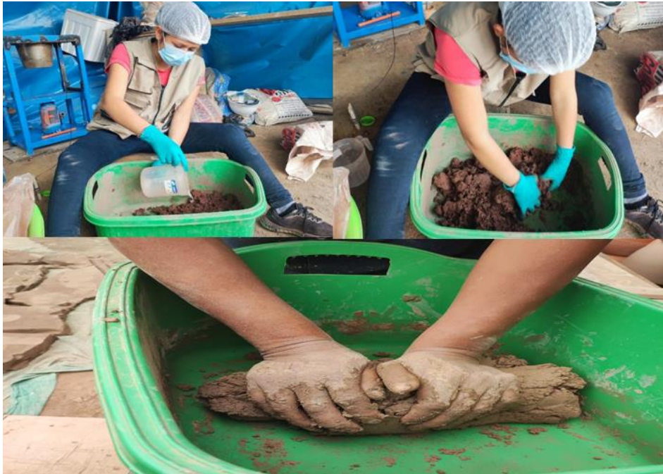
Figura 14. Mezclando la arcilla y aserrín con el agua – Alfarería Saul.
