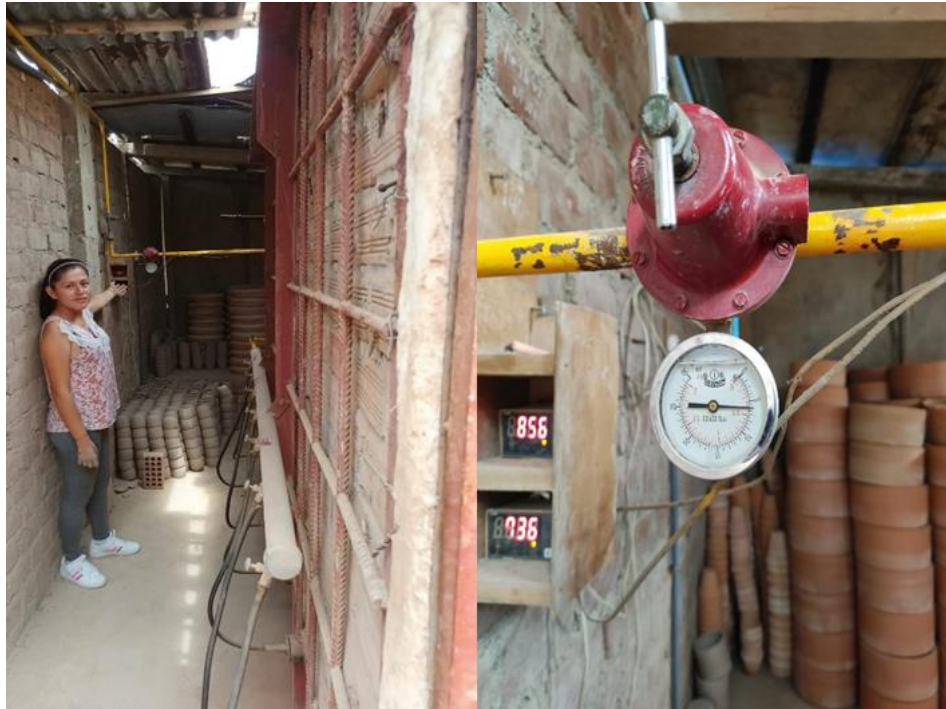
Figura 20. Control de la temperatura de cocción.
