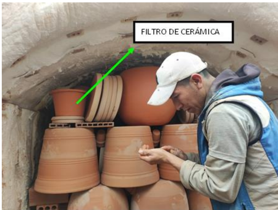
Figura 19. Cocción del filtro en un horno industrial por 12 horas.
