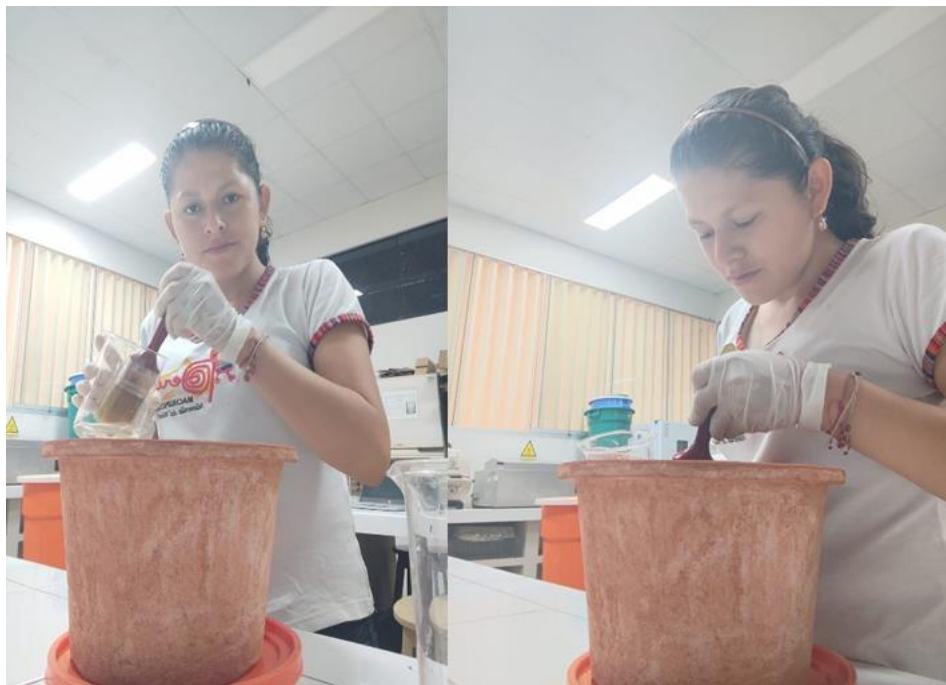
Figura 25. Adición de tres capas de plata coloidal a los filtros de cerámica.
