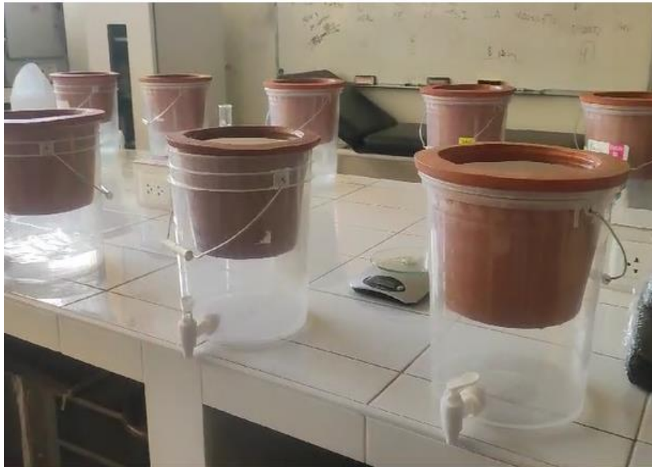
Figura 24. Prueba de filtración de la unidad filtrante.
