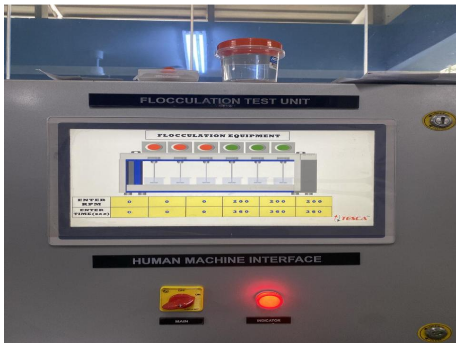
Figura 31. Equipo de Test de jarras con un espacio de 6 vasos precipitados
