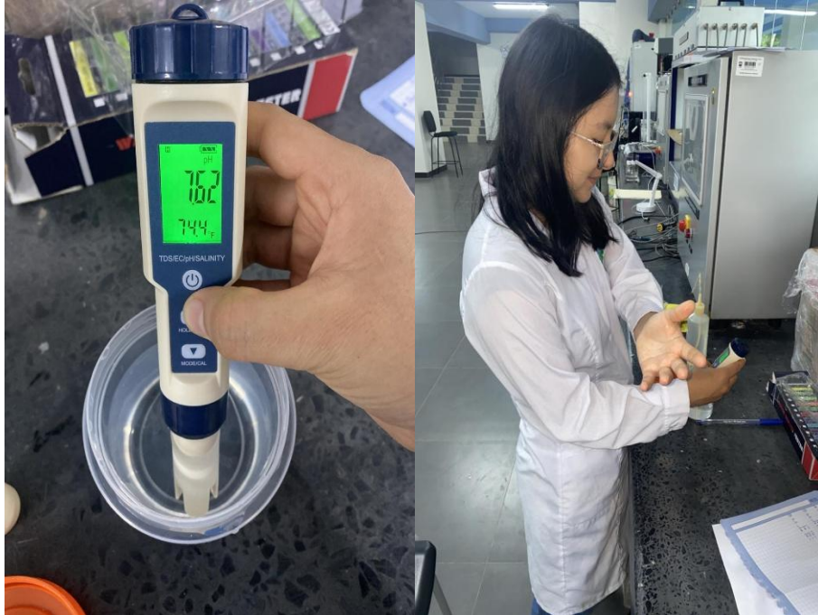
Figura 30. Acondicionamiento del pH en las diferentes muestras de agua superficial
