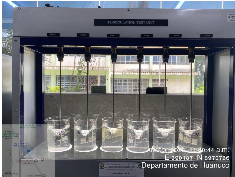
Figura 32. Test de jarra con el coagulante natural
