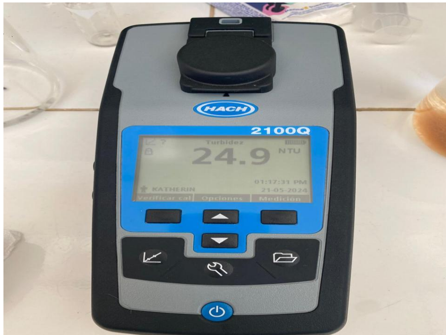
Figura 37. Mediciones de la turbidez en las muestras de agua con lluvia
