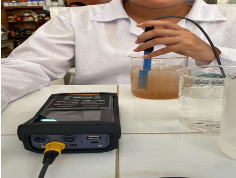
Figura 34. Medición de la turbidez inicial de las diferentes muestras de agua
