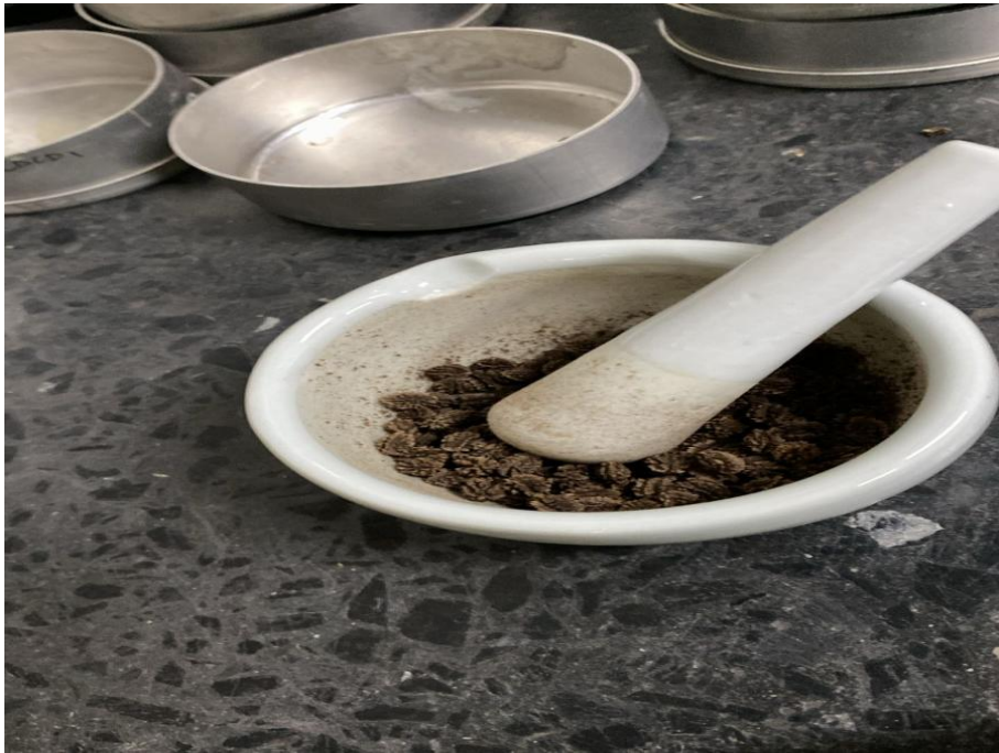
Figura 28. Trituración manual de las semillas secas de Carica papaya
