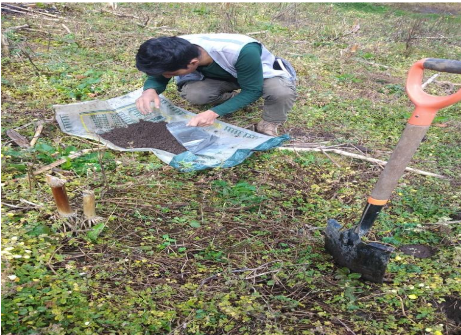
Figura 15. Cuarteo y mezclado de la muestra de suelo
