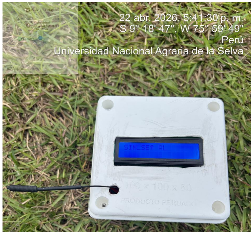
Figura 25. Equipo receptor con perdida se señal del equipo transmisor
