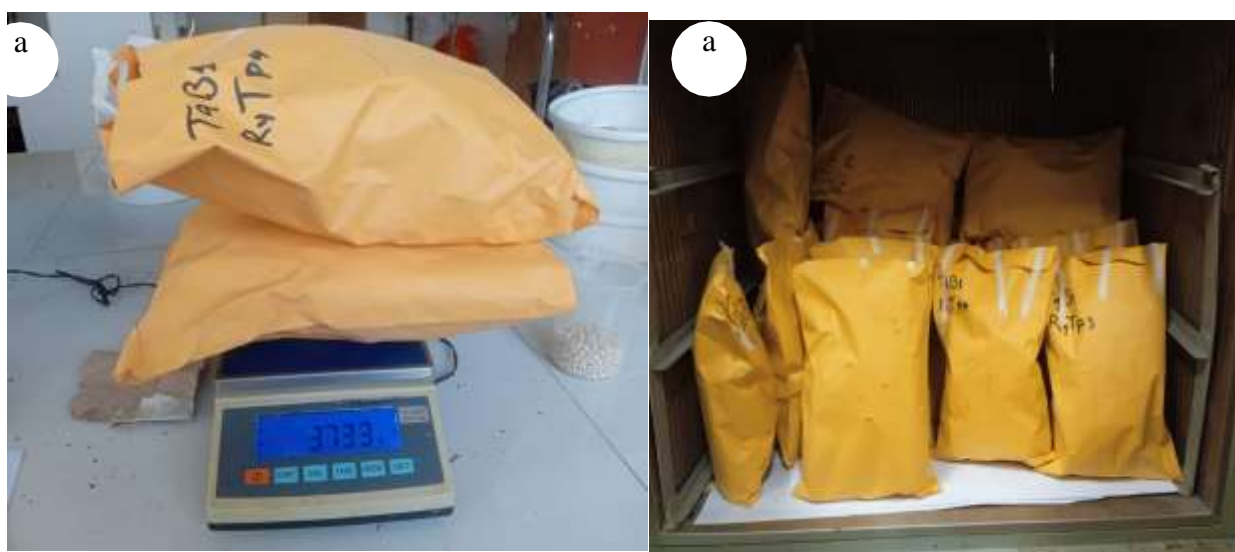
Figura 51. Materia seca: (a) Peso de la materia fresca en una balanza granera, (b) Muestras en estufa.
