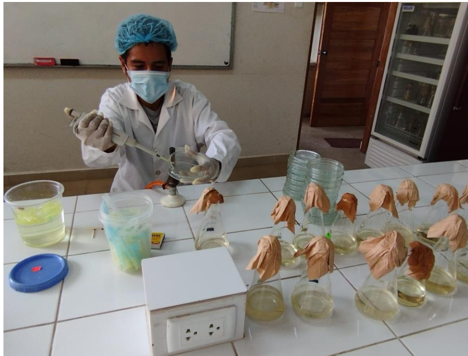
Figura 21. Adición de 1 \mu\text{l} de la muestra para realizar el recuento microbiológico
