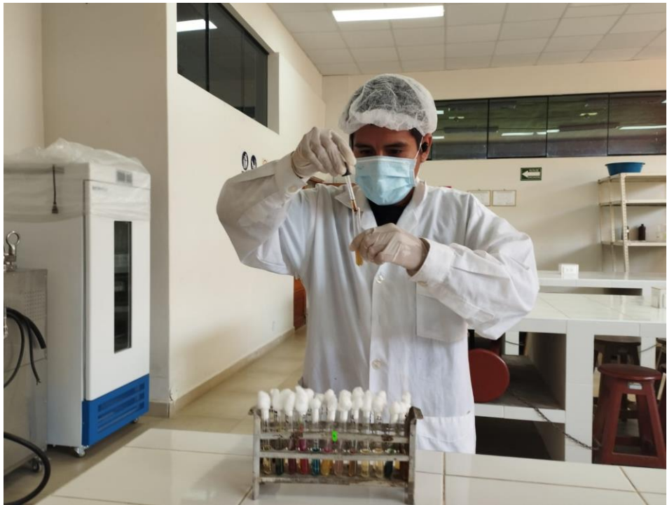
Figura 28. Adición del reactivo de KOVAC a los tubos con indol
