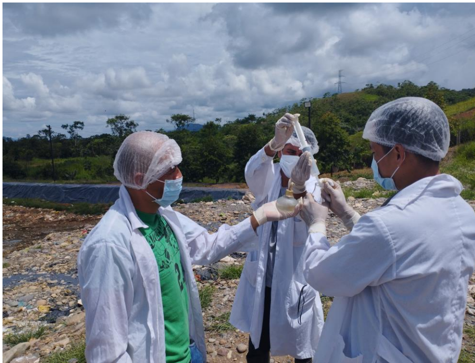
Figura 20. Muestra de aire succionado depositado en el matraz con caldo BHI
