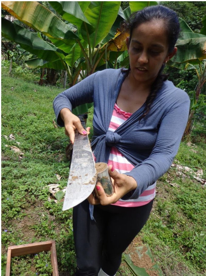
Figura 06. Muestreo para determinar la densidad aparente del suelo.
