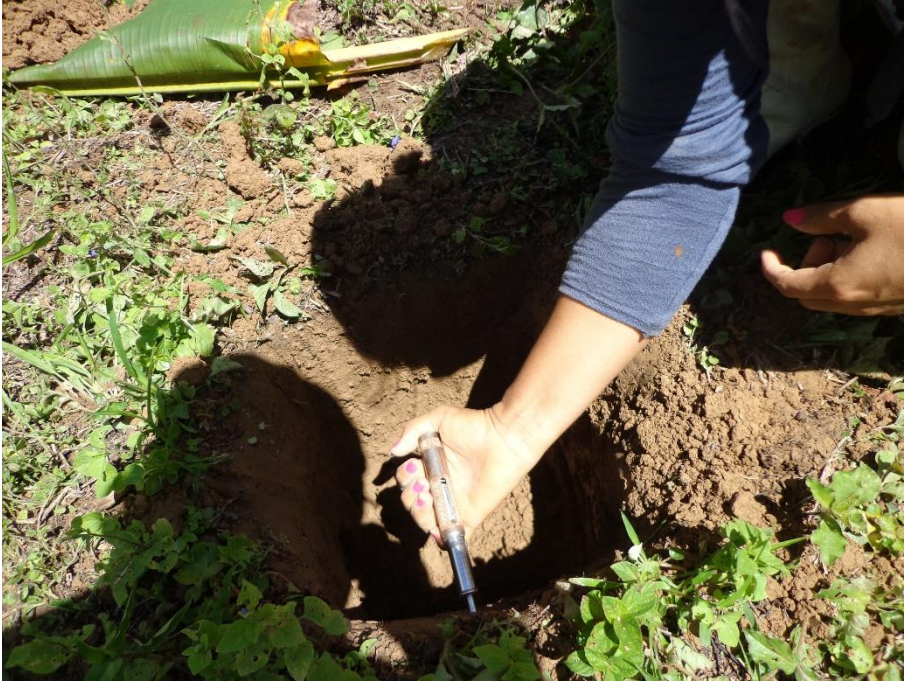
Figura 05. Medición de la resistencia del suelo con cultivo de plátano.
