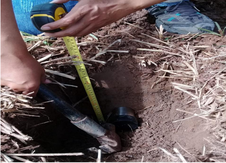
Figura 18. Muestreo de densidad aparente del suelo en parcela con sistema agroforestal de cacao
