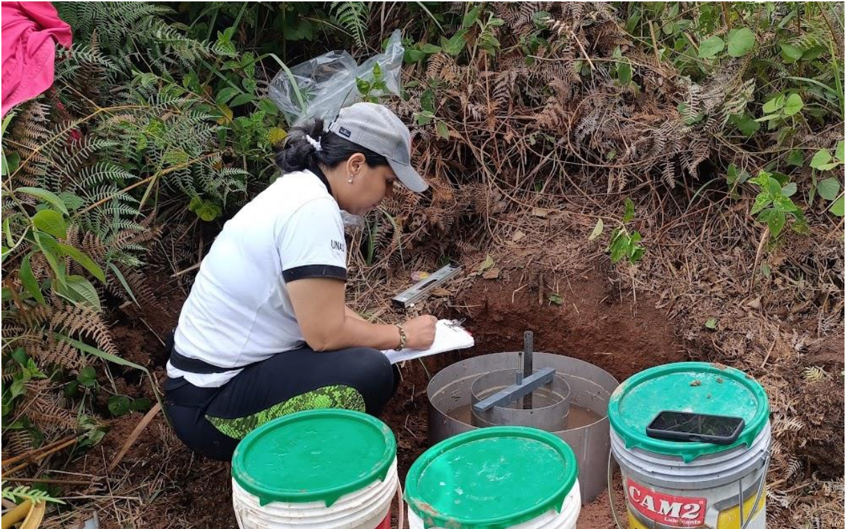
Figura 23. Lectura de datos de la cantidad de agua desplazada por infiltración.
