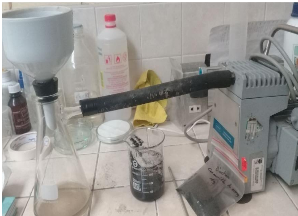
Figura 30. Extracción de la solución (p/v) luego de la centrifugación.
