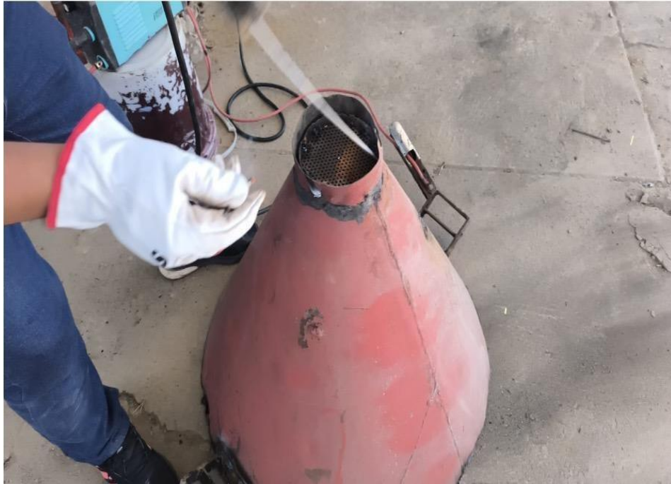
Figura 21. Preparación de Horno pirolítico KON TIKI
