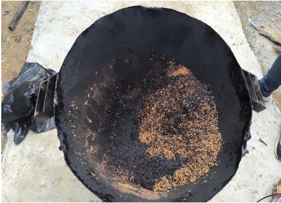
Figura 25. Proceso del desarrollo de la producción de biochar
