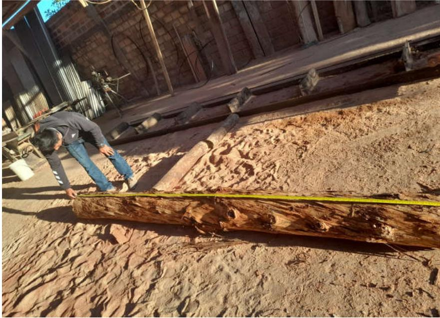
**Figura 17.** Medición de la longitud de una troza de *P. tecunumanii*
