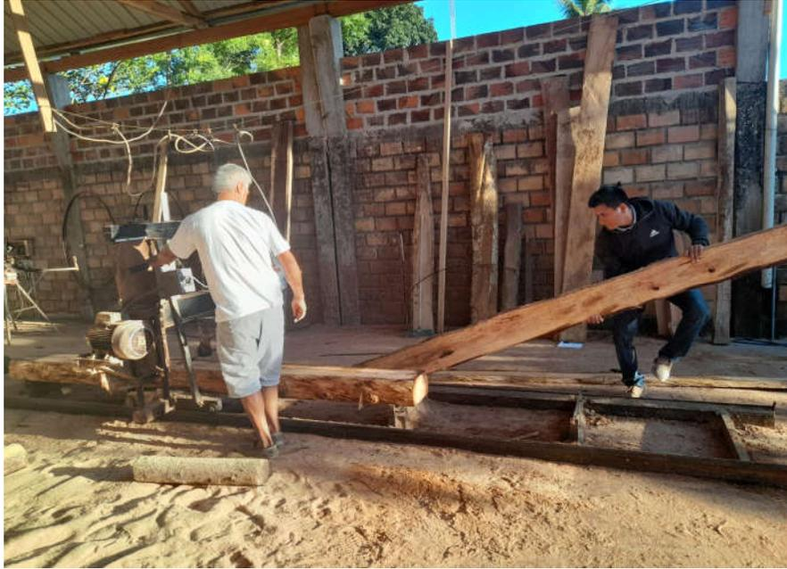
**Figura 21.** Obtención de una tabla comercial
