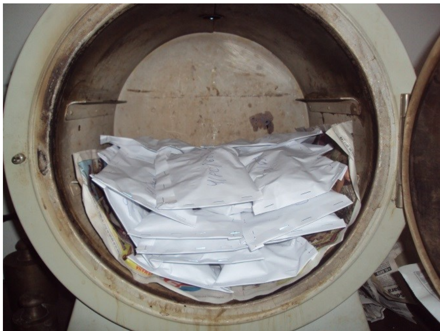
Figura 21. Secado de la muestra del suelo a diferentes estratos en la estufa a 80 °C por 72 horas.
