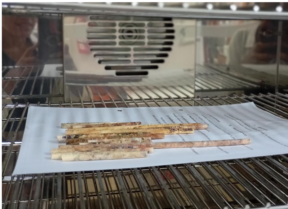
Figura 5. Muestra de cilindros de madera en proceso de secado en horno
