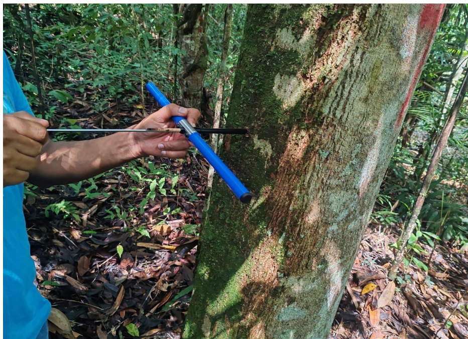
Figura 3. Extracción de un cilindro de madera a partir de un árbol de J. copaia .
