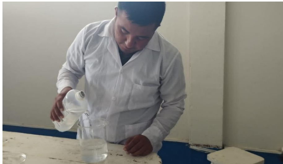
Figura 8. Medición del volumen de agua para hidratación de la dolomita
