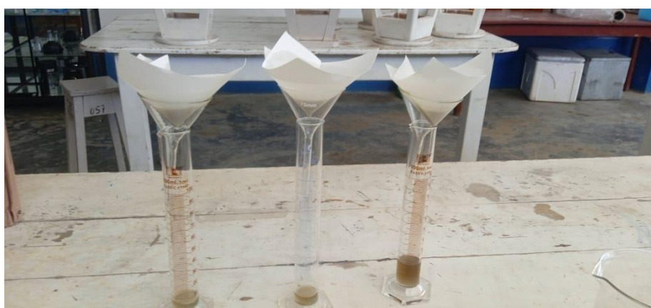
Figura 16. Filtración del lixiviado tratado con dolomita
