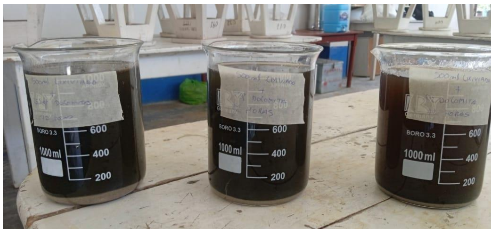
Figura 15. Tratamiento de lixiviado con aplicación de dolomita.
