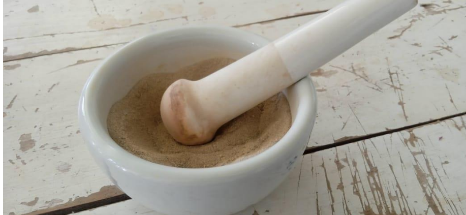
Figura 7. Trituración de la dolomita
