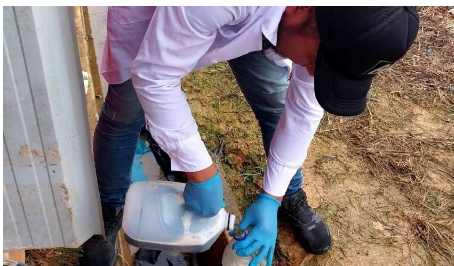
Figura 14. Toma de muestras de lixiviado
