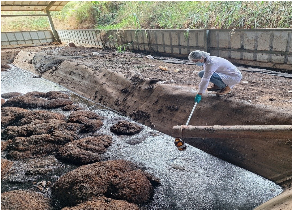
Figura 4. Toma de muestra de los efluentes de la Planta de Valorización (M2)
