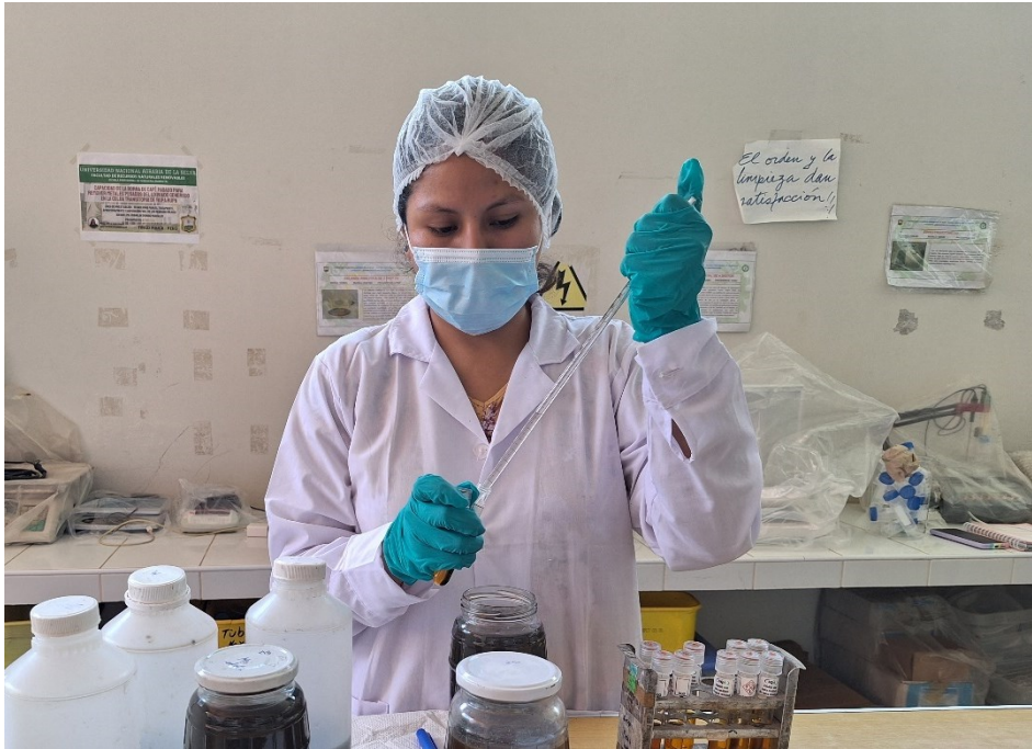
Figura 11. Adición de la muestra a los tubos de digestión para su lectura de DQO.
