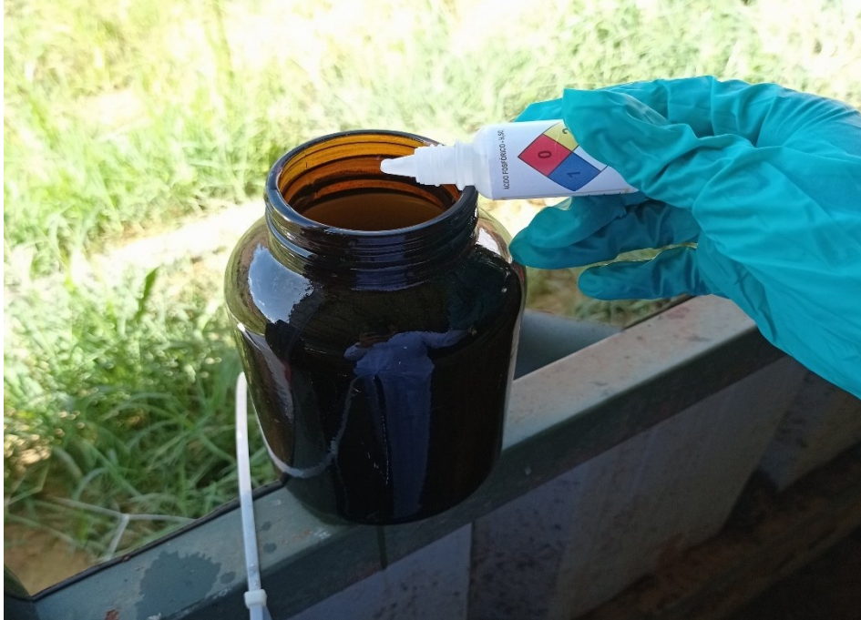
Figura17. Adición de HCl para conservación de muestras de efluentes para análisis de aceites y grasas
