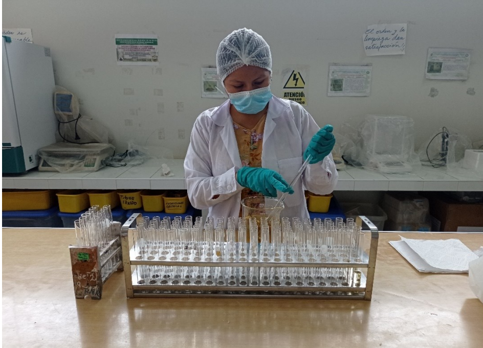
Figura 7. Proceso de inoculación para la lectura de coliformes termotolerantes.
