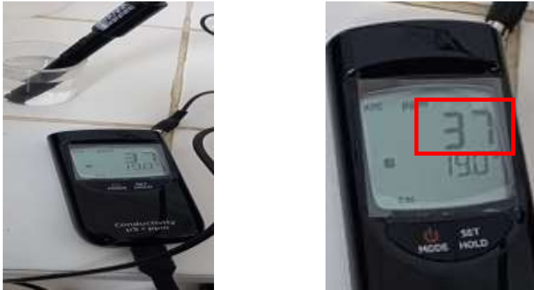
Figura 7. Verificando la conductividad del agua de manantial
