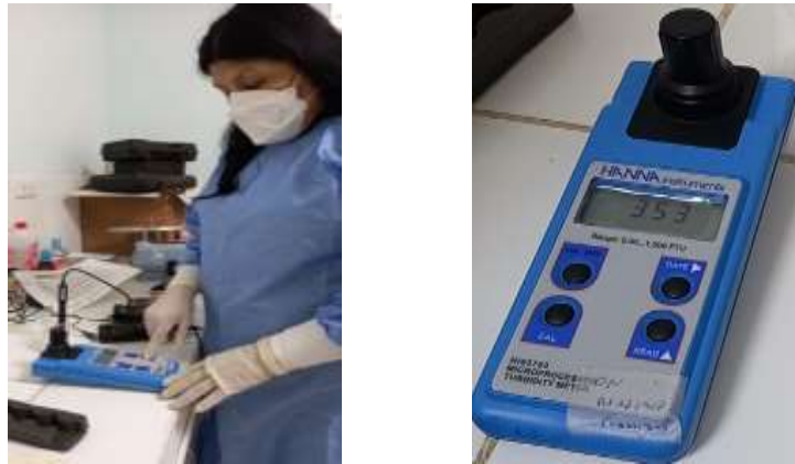
Figura 9. Contrastando la turbidez del agua de manantial
