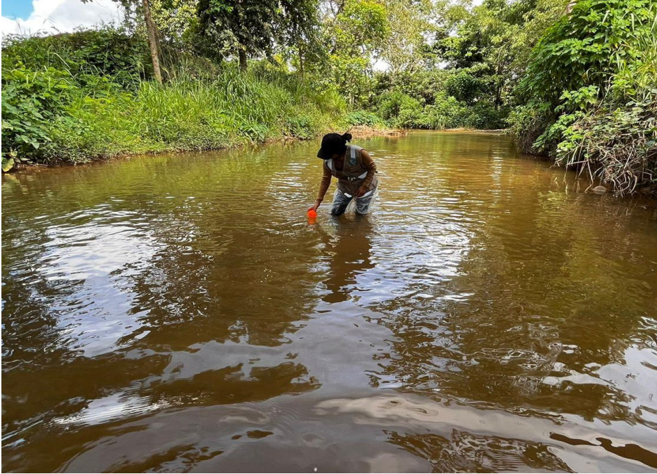
Figura 27. Medición del tiempo de llegada del flotador.
