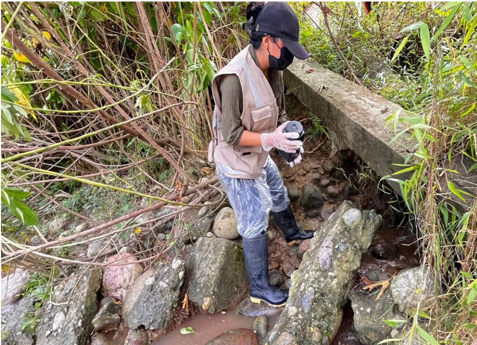
Figura 32. Recolección de muestra del punto 2 para el análisis de \text{DBO}_5 .
