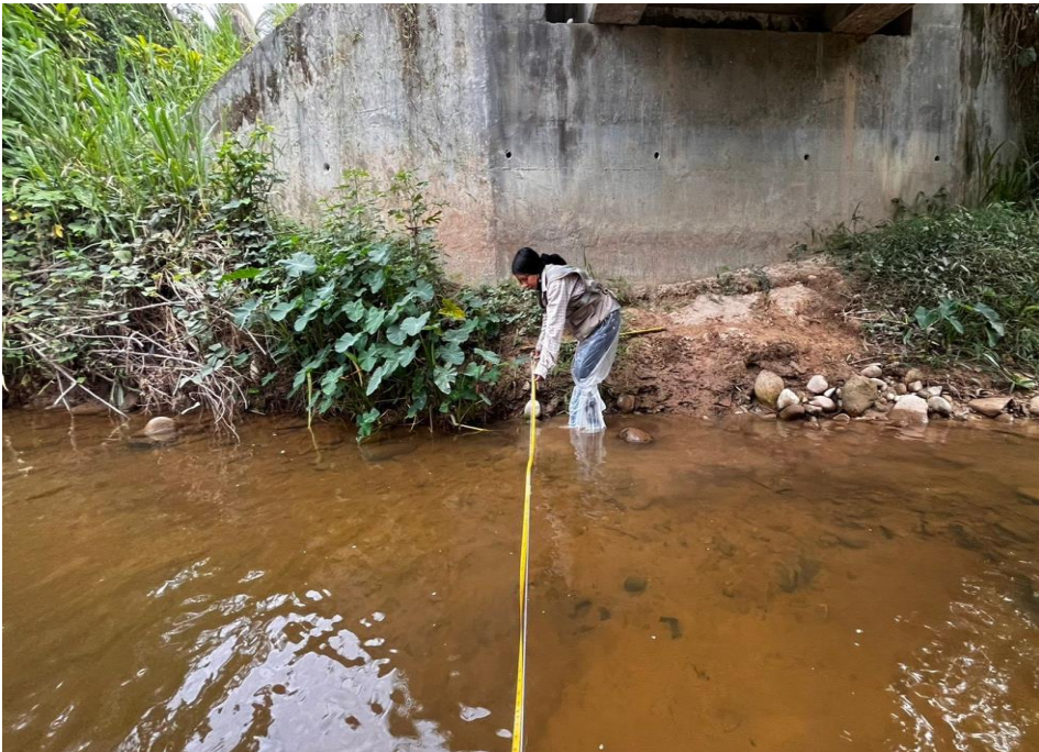
Figura 28. Medición del ancho de la quebrada Pucayacu.
