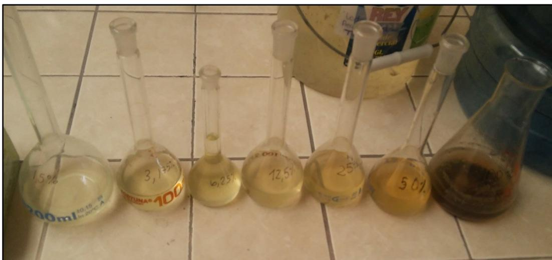
Figura 23. Concentración de extracto de hidrocarburo para realizar los ensayos.
