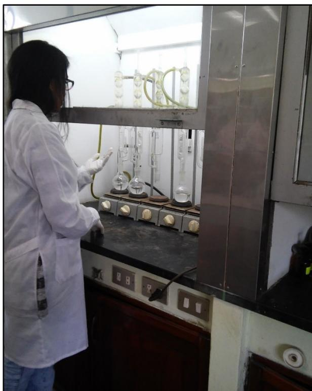
Figura 21. Extracción de Soxhlet del suelo contaminado.
