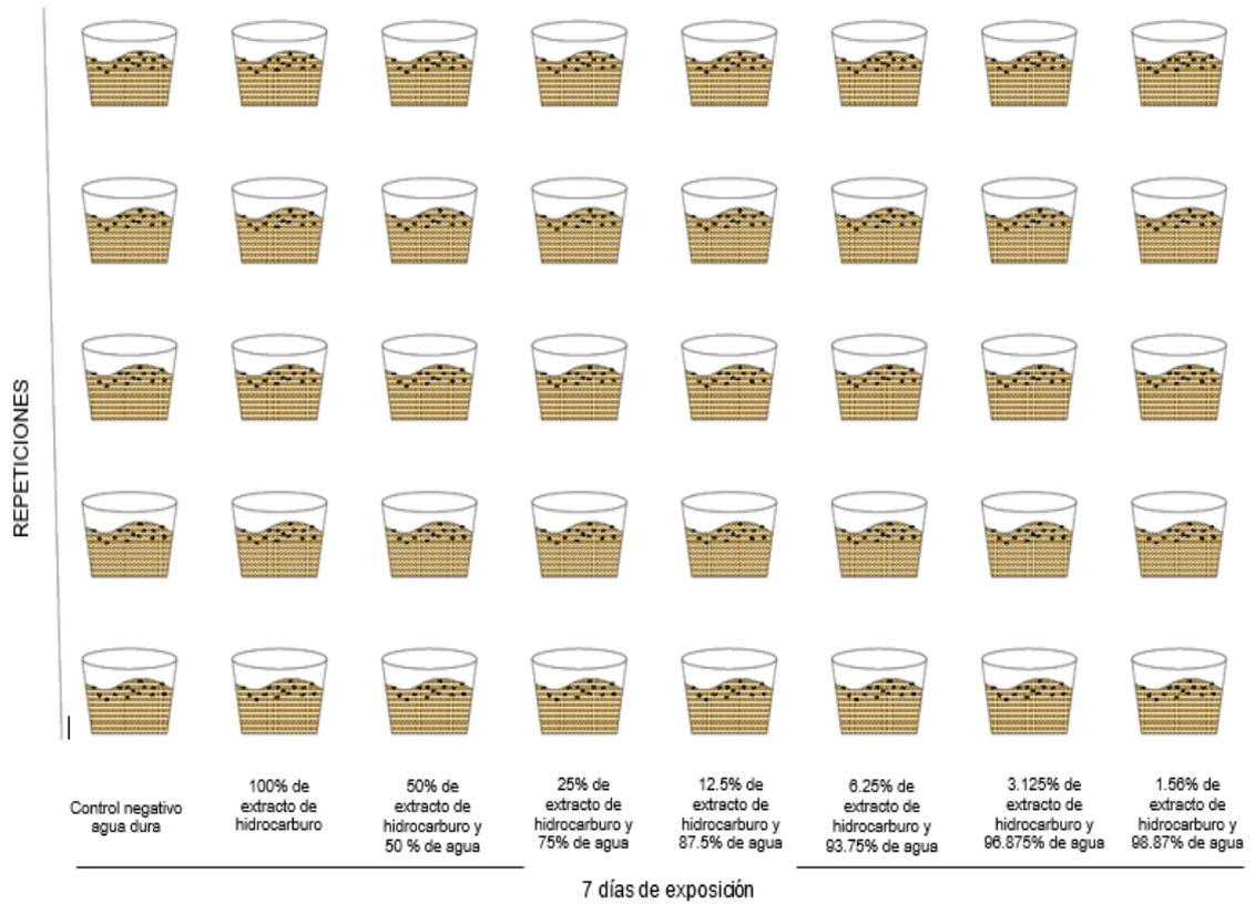
**Figura 4.** Se sintetiza el procedimiento del ensayo de toxicidad en macetas.
