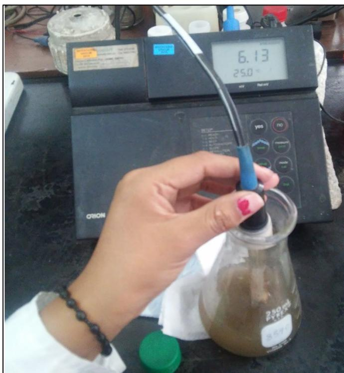
Figura 22. Medición del pH para el suelo contaminado.
