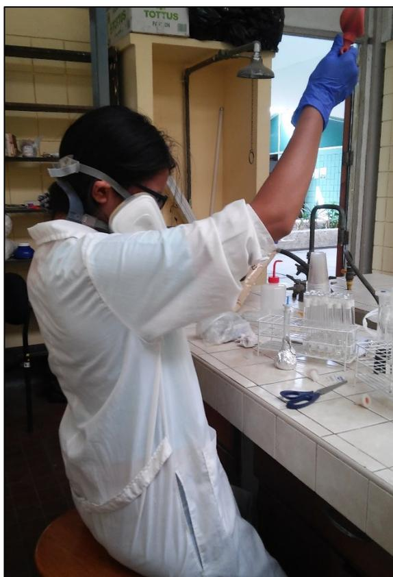
Figura 20. Preparación con diclorometano para la extracción del hidrocarburo
