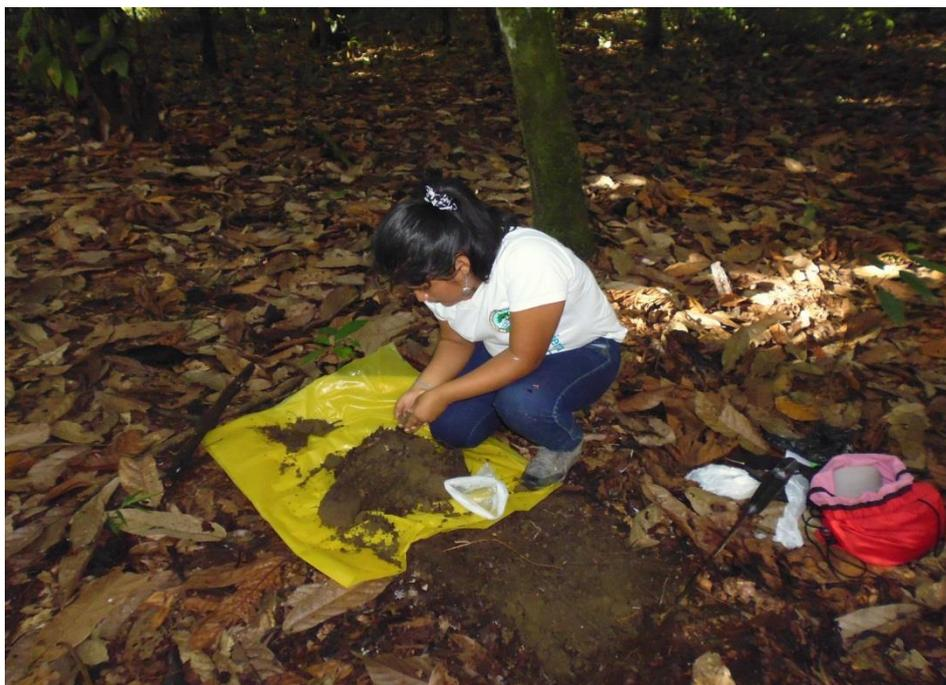
Figura 22. Homogenizando la muestra de suelo
