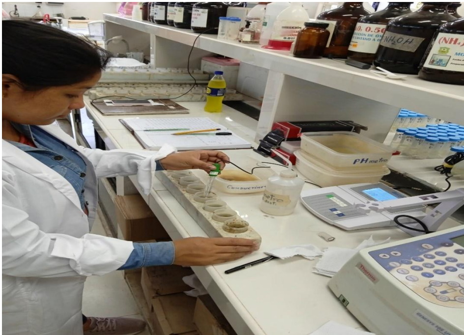
Figura 21. Medición del pH en los suelos de estudio con el peachímetro digital
