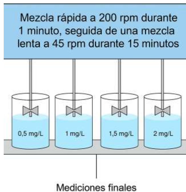
Figura 3. Esquema experimental de las especies de Croton lechleri y Croton draconoides como coagulante-floculante
