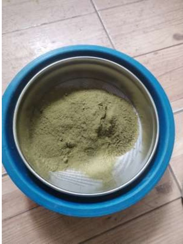
Figura 40. Tamizado del material particulado de la corteza del tallo, hojas y raíz secundaria
