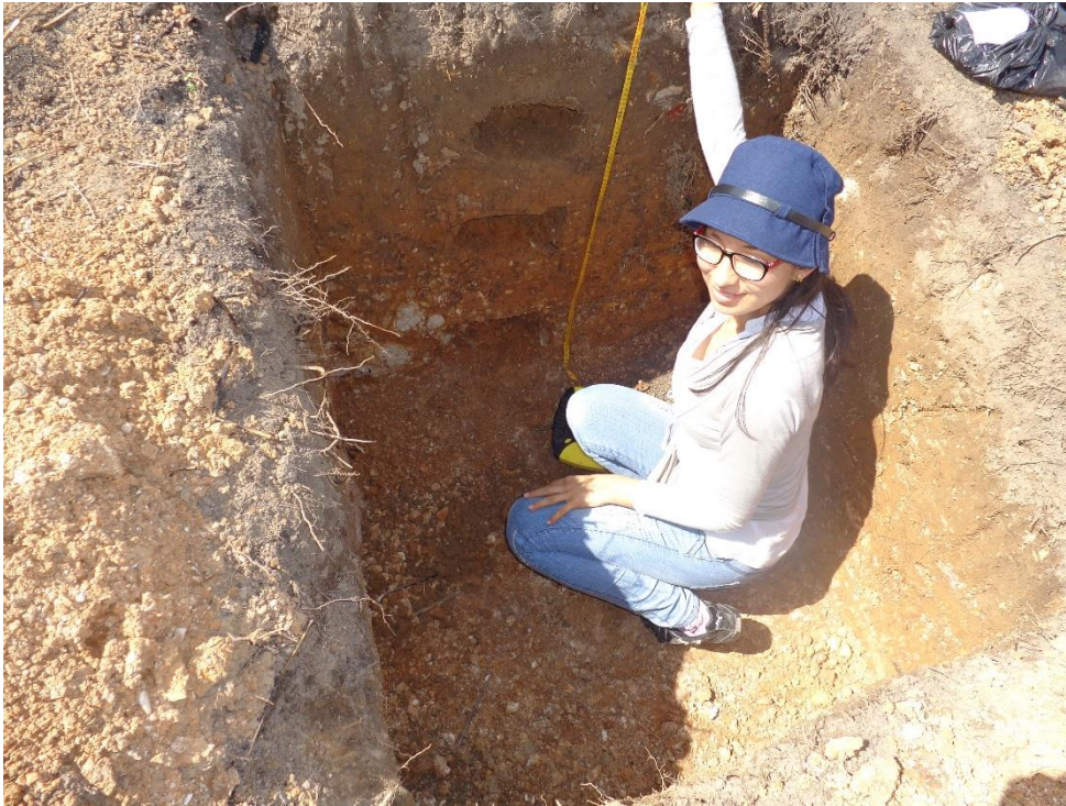
Figura 18. Observación de propiedades de calicatas.
