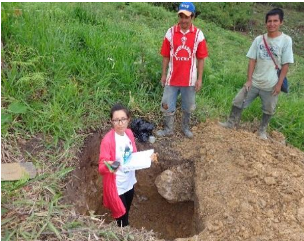
Figura 19. Determinación de horizontes de calicata.
