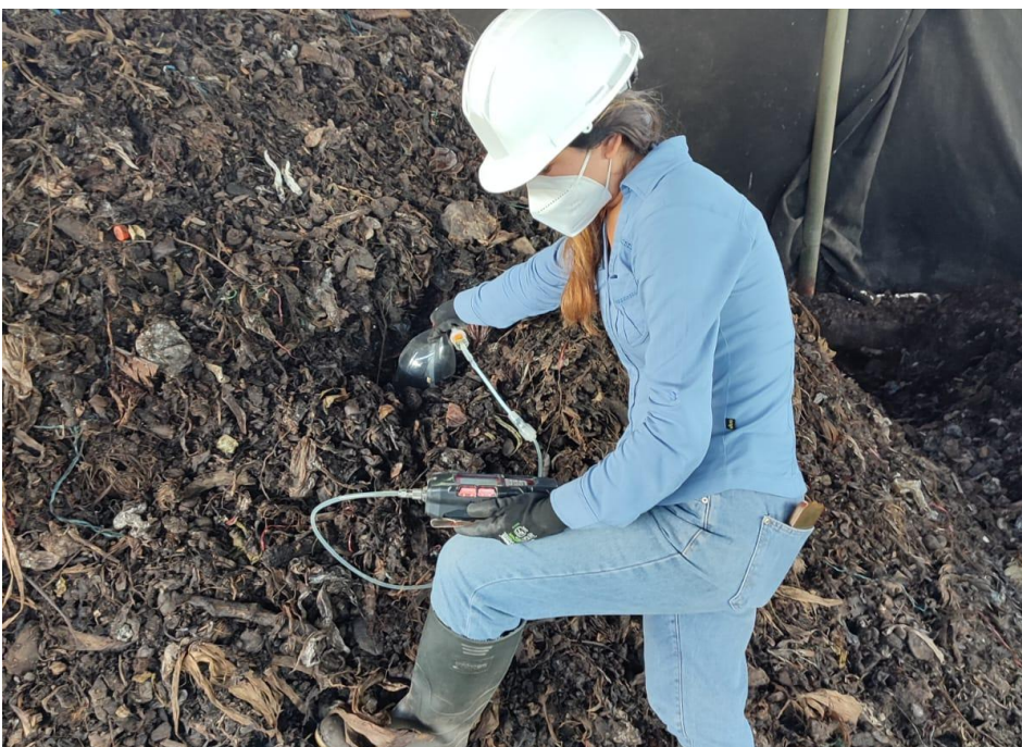
Figura 24. Medición De Gases CO, CO 2 , CH 4 en el punto 3.
