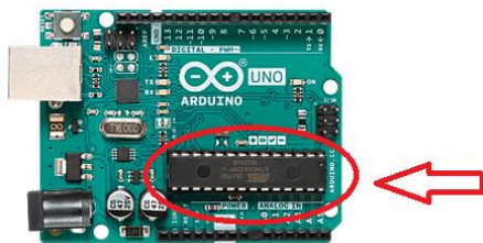
Figura 10. Microcontrolador en el Arduino Uno
