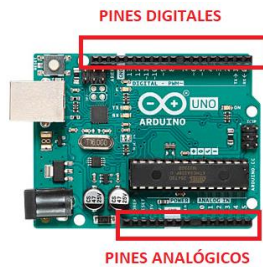
Figura 11. Pines analógicos y digitales en el Arduino Uno
