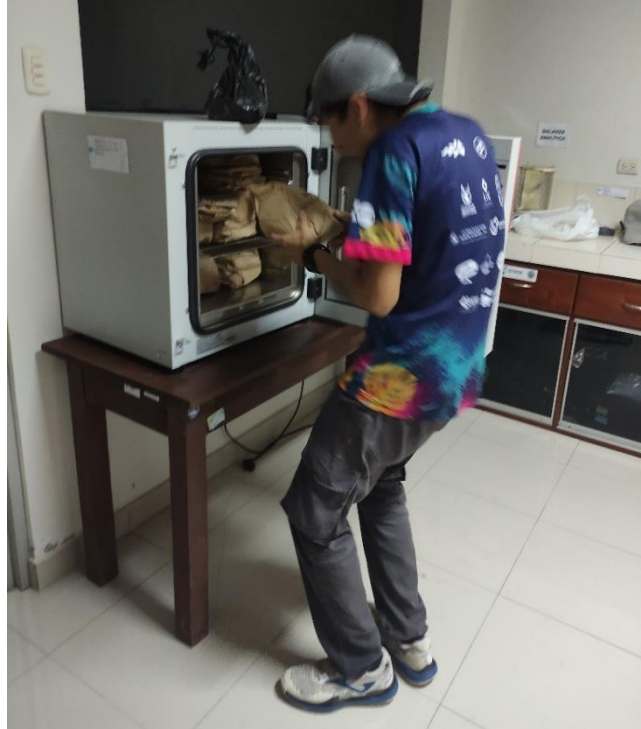
Figura 31. Colocado de muestras en el horno para el secado correspondiente a 70 °C.
