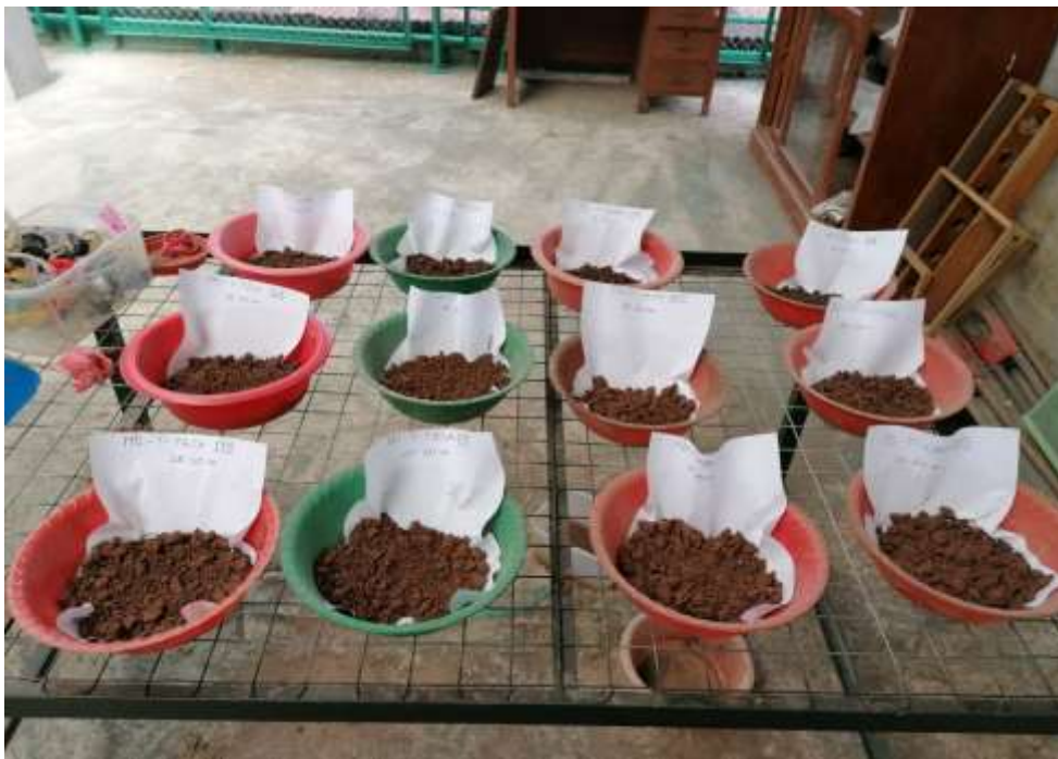
Figura 12. Secado del suelo al aire libre bajo cubierta
